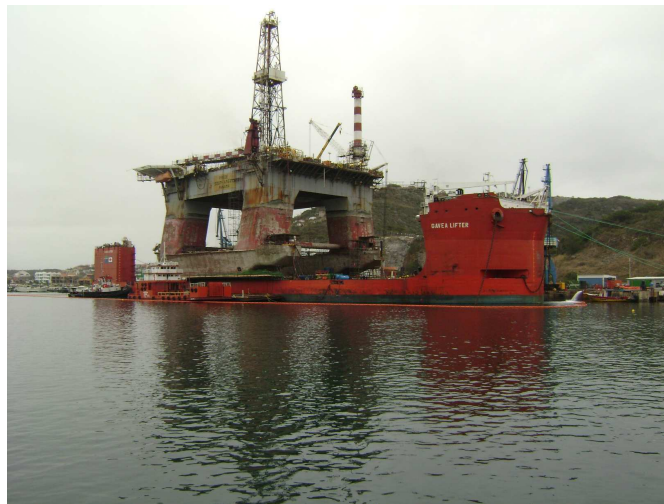
Figura 4.8.1. Emprego de navios doca para reparo de plataformas no Porto do Forno.
