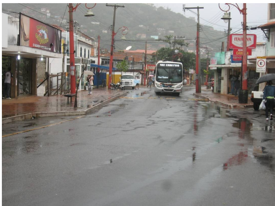
Foto C – Na falta de sinalização divisória de pista o comportamento dos motoristas acaba sendo inadequado e o veículo circula no meio da pista
