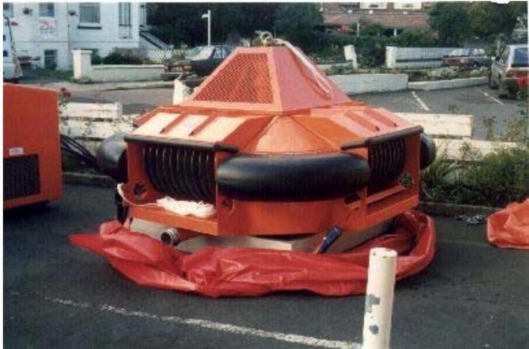
FIG 20 – Cabeça de Recuperação Circular de um Recuperador de Discos Oleofílicos de Cerca de 50 m 3 /h de Capacidade
