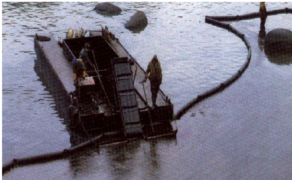
FIG. 27- Sistema de Tapete ou Correia
