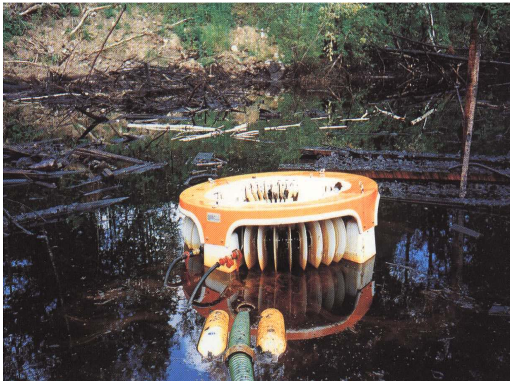
FIG 17 – Cabeça de Recuperação Circular de um Recuperador de Discos Oleofílicos de Cerca de 12 m 3 /h de Capacidade
