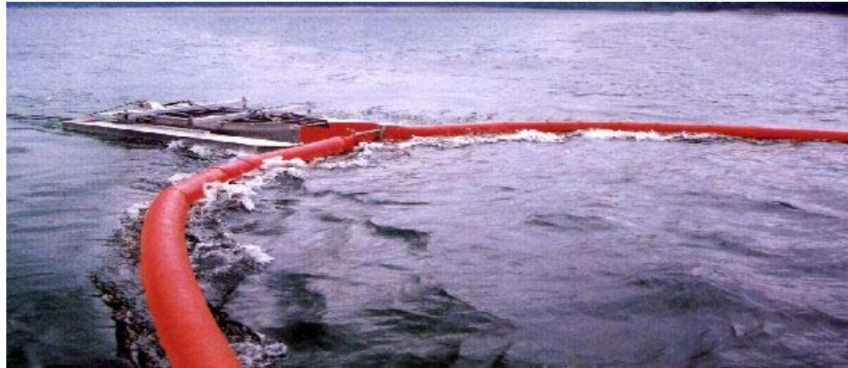
FIG 14 – Recuperador de Escoamento para Velocidades Elevadas Funcionando em Recolha Dinâmica com Dois Navios
