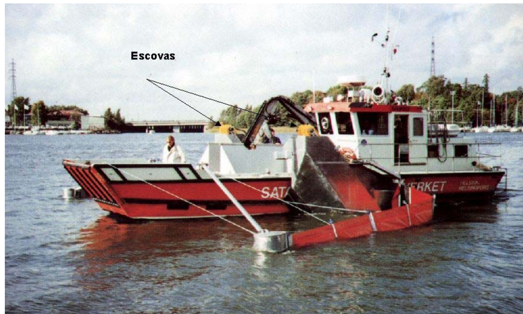
FIG 32 – Embarcação com Sistema de Escovas em Cada Bordo
