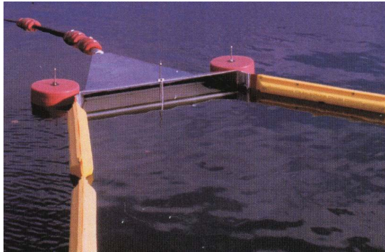
FIG. 3 - Cabeça de um Recuperador de Sucção
