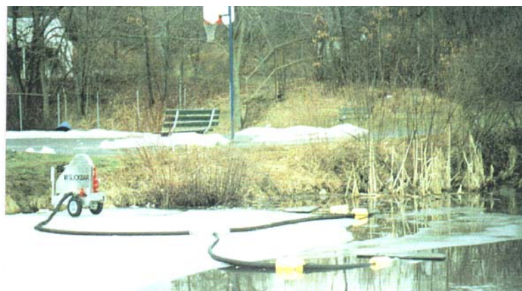
FIG. 2 - Recuperador com 2 Cabeças de Sucção
