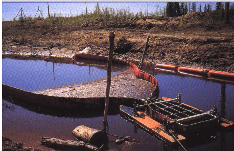
FIG 15 – Recuperador de Escoamento para Velocidades Elevadas Funcionando em um Curso de Água com Barreiras Tipo “Fence”.
