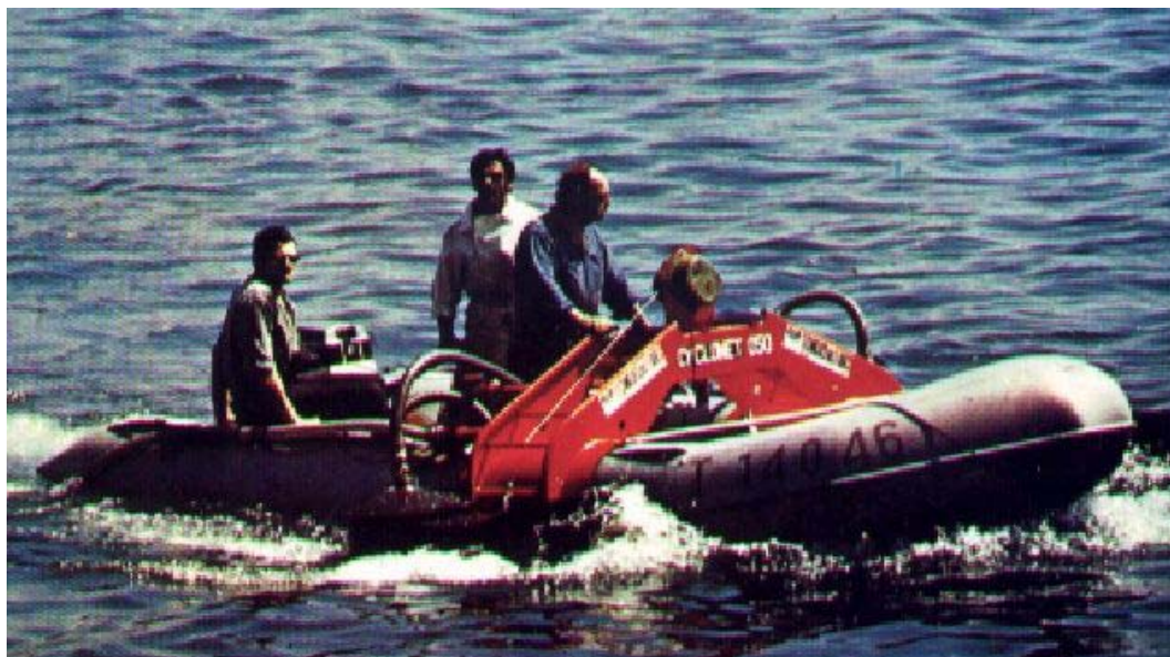
FIG 37 – Recuperadores de Hidrociclone Instalados numa Embarcação Pequena
