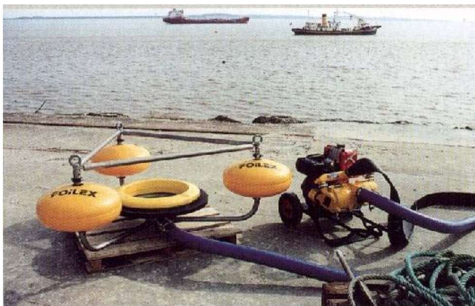
FIG 8 - Recuperador de Escoamento (Weir) com Bomba Externa
