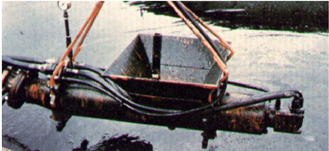
Fig 40 – Bomba de Arquimedes Funcionando como Recuperador no Mar
