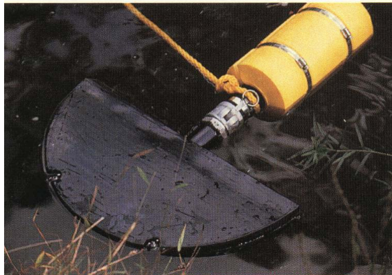
FIG. 4 - Cabeça de um Recuperador de Sucção
