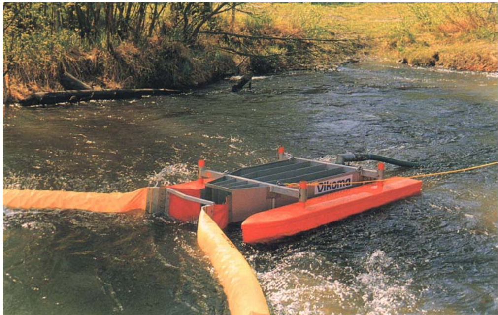
FIG 12 - Recuperador de Escoamento para Velocidades Elevadas Funcionando em Águas Agitadas
