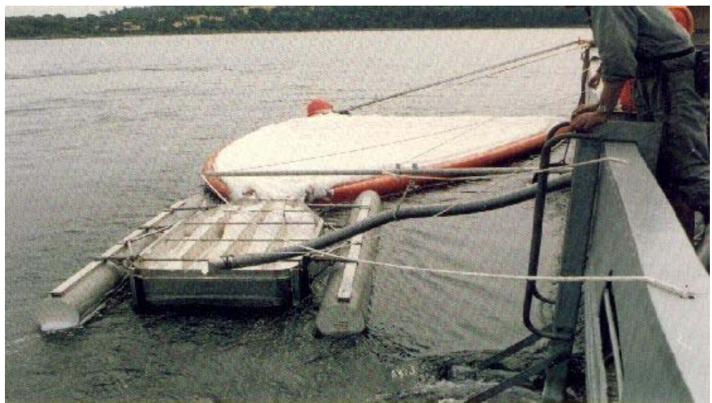
FIG 13 – Recuperador de Escoamento para Velocidades Elevadas Funcionando em Recolha Dinâmica num Navio
