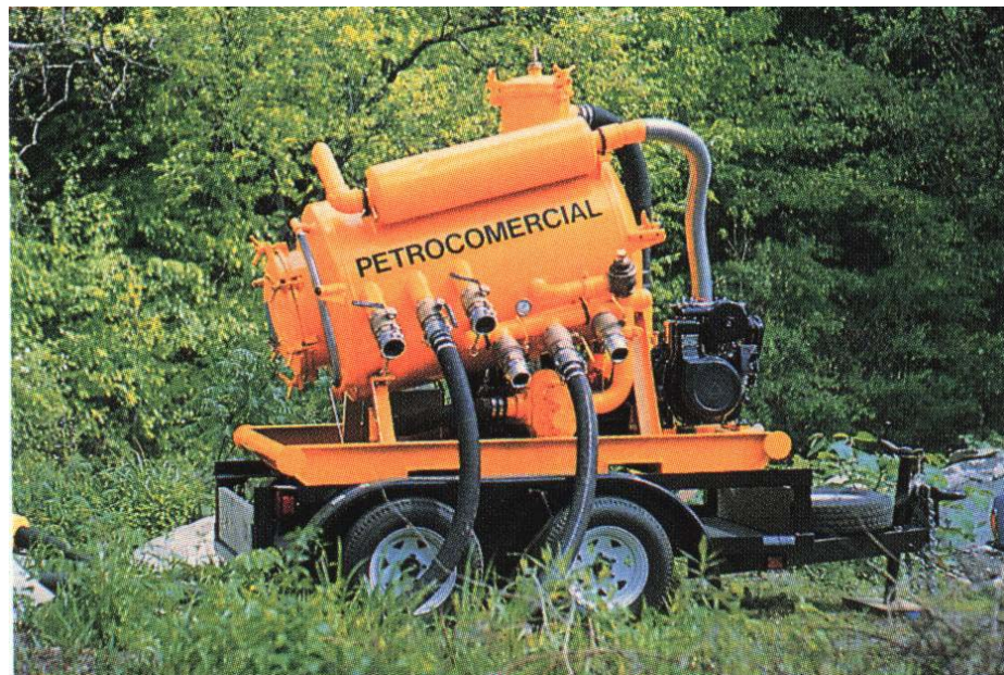
FIG. 45 - Sistema de Aspiração por Vácuo
