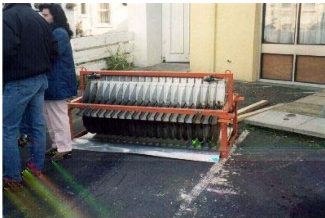
FIG 19 – Cabeça de Recuperação Retangular de um Recuperador de Discos Oleofílicos de Cerca de 12 m 3 /h de Capacidade
