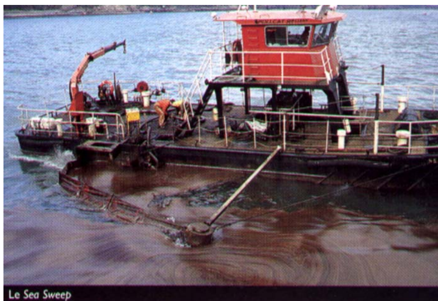
Fig. 7m– Barreira em Recolha Dinâmica por um Navio
