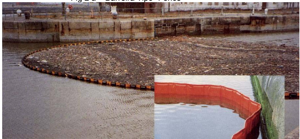
Fig 2 b – Barreira Tipo "Fence"
