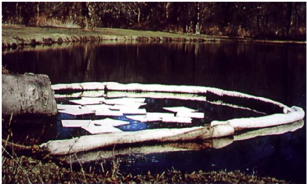
Fig 5 a – Barreira Absorvente
