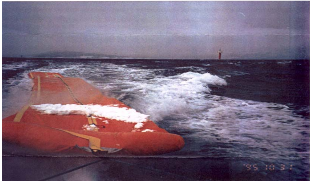
Fig. 7v – Barreira de Colocação Rápida em Sacos
