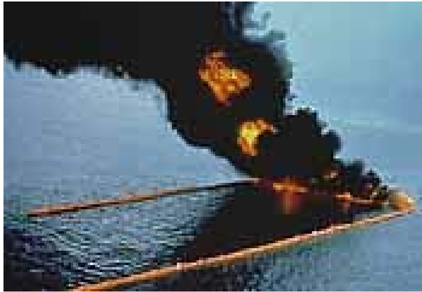
Fig 3 e – Barreira Resistente ao Fogo
