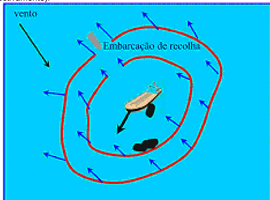
Fig. 7n – Barreira em Forma de Circulo com Abertura para Embarcações
