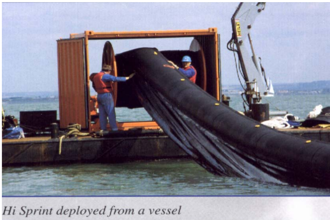
Fig. 7w – Barreira em Enrolador Hidráulico
