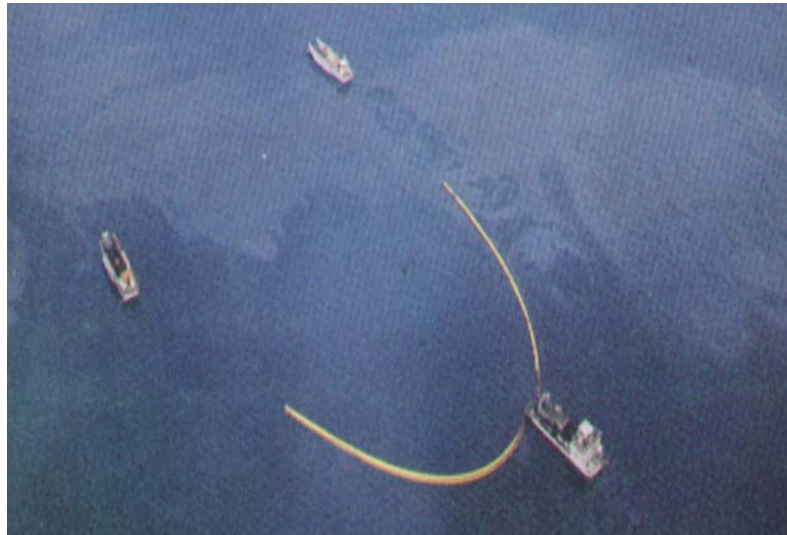
Fig. 7t – Barreira Rebocada em Utilização Dinâmica por Dois Navios e um Terceiro em Operação de Recolha
