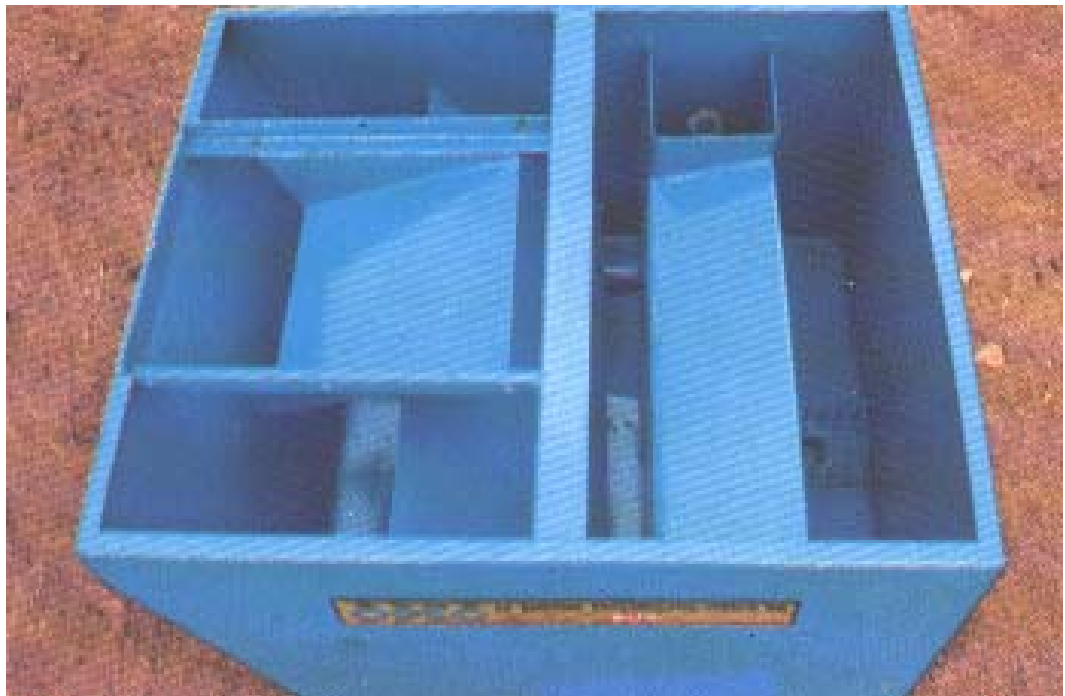
Figura 17 – Tanque de decantação/separação
