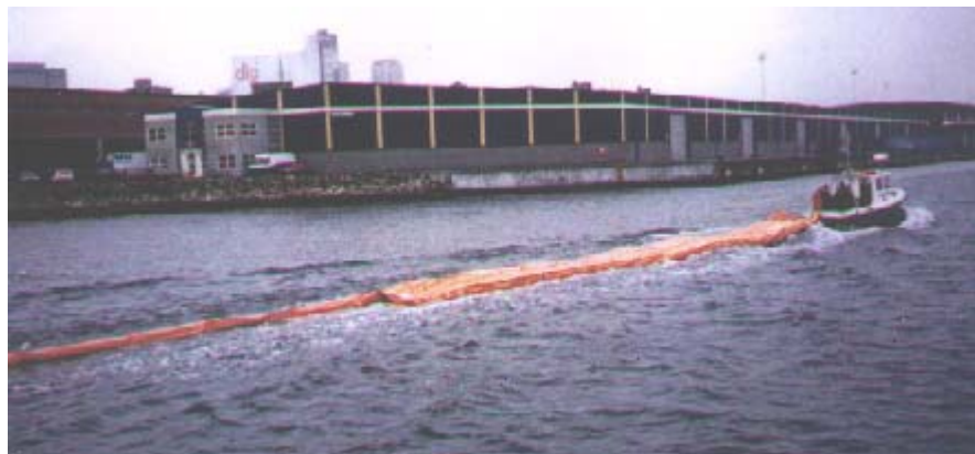
Figura 12 – Barreira em saco rebocada por embarcação
