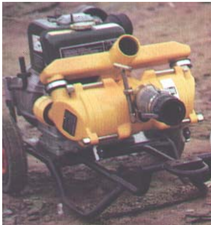
Figura 20 – Bomba de Transferência
