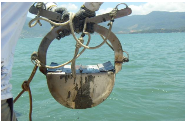
Figura 4.1 - Draga do tipo van Veen utilizada para coleta de sedimento superficial.
