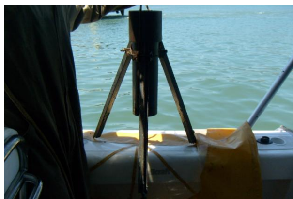
Figura 4.4.4 - Equipamento utilizado para fixação do testemunho no sedimento.
