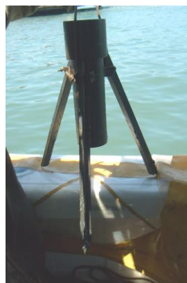
Figura 4.3 - Equipamento utilizado para fixação do tubo de alumínio no sedimento
