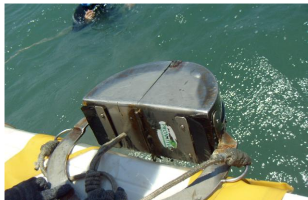
Figura 4.1 - Draga do tipo van Veen utilizada para coleta de sedimento superficial.
