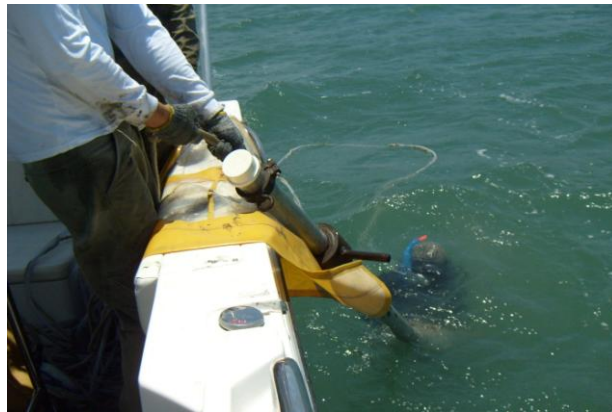
Figura 4.2 - Retirada do tubo de alumínio por um mergulhador contendo o sedimento coletado
