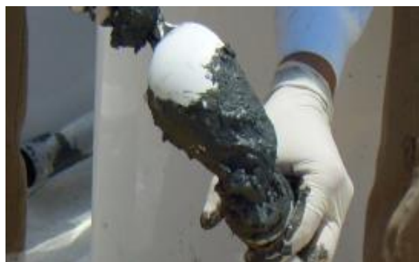
Figura 4.4.5 - Amostra de sedimento sendo acondicionada em frascos apropriados.
