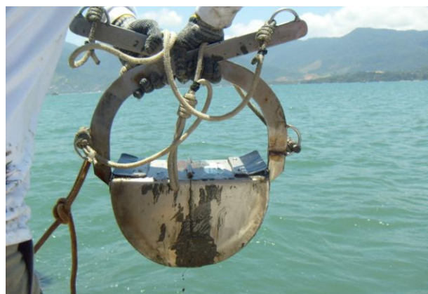
Figura 4.1.1 - Utilização do pegador van Veen para a amostragem de sedimento superficial.
