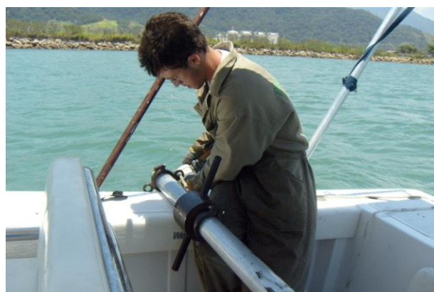
Figura 4.1.3 - Retirada do material coletado de dentro do testemunho
