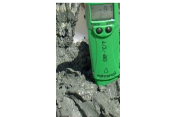
Figura 4.4.6 Medidas físico-químicas in situ nas amostras de sedimento.
