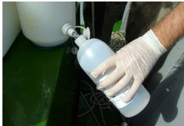
Figura 2.1.9 - Acondicionamento das amostras de água em frascos apropriados.
