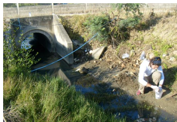
Figura 2.1.3 - Amostragem no ponto PA-2, mostrando a tubulação que liga o córrego ao corpo de água marinho.
