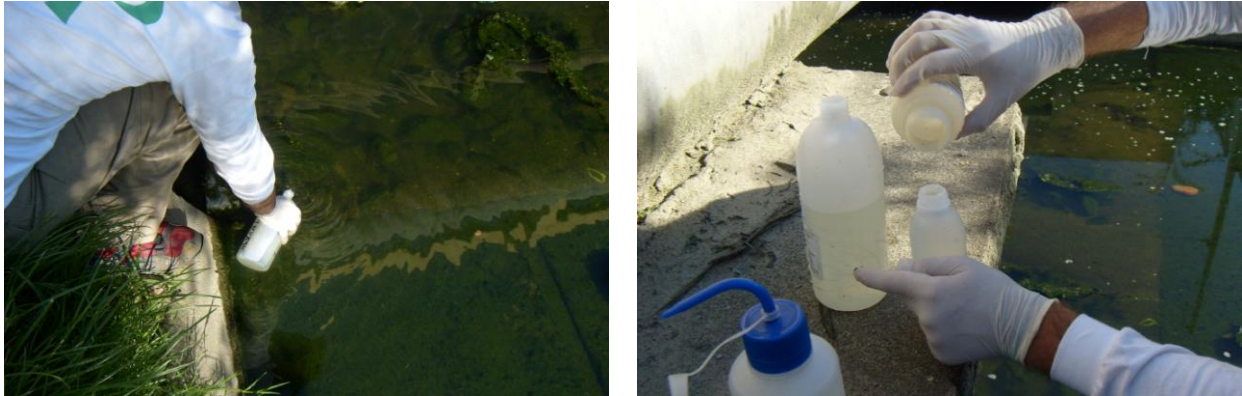
Figura 2.1 - Amostragem de água da camada superficial, através da imersão direta de um frasco sem preservante no corpo de água, com posterior transferência para os frascos contendo preservante.
