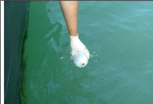
Figura 2.1.7 - Amostragem de água superficial, através da imersão direta dos frascos no corpo de água.
