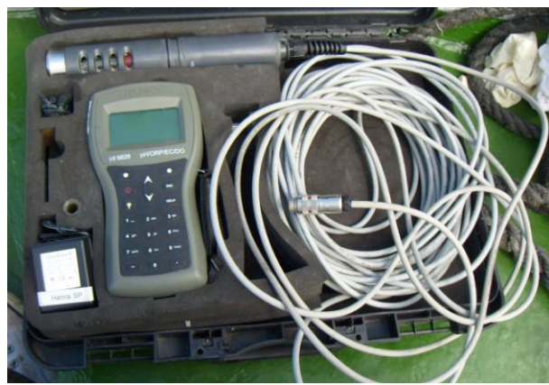
Figura 2.1.11 - Sonda multiparamétrica da marca HANNA, utilizada para as medições físico-químicas in situ na água.
