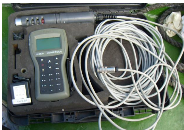
Figura 11 - Sonda multiparamétrica da marca HANNA, utilizada para as medições físico-químicas in situ na água.
