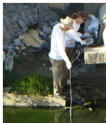
Figura 12 - Realização das medidas físico-químicas in situ no corpo de água (PA-3).
