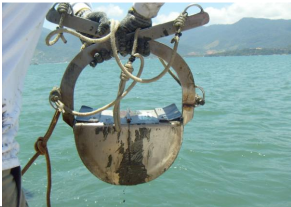
Figura 1 - Utilização do pegador van Veen para a amostragem de sedimento superficial.
