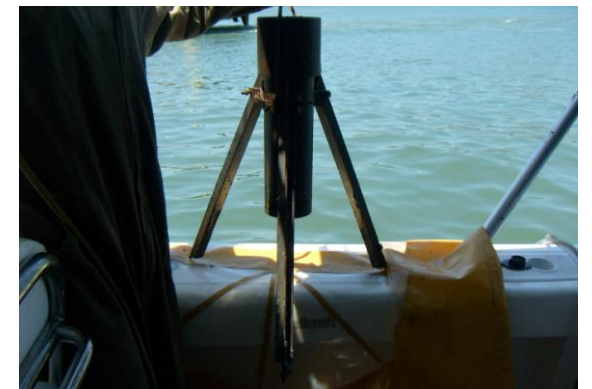
Figura 4 - Equipamento utilizado para fixação do testemunho no sedimento.
