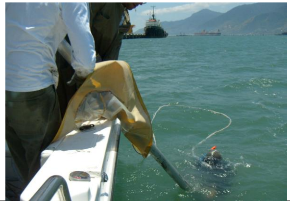
Figura 2 - Retirada do testemunho, com o auxílio de um mergulhador, para a coleta de sedimento sub-superficial.
