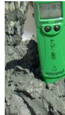
Figura 6 - Medidas físico-químicas in situ nas amostras de sedimento.
