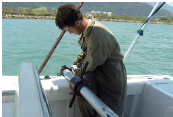
Figura 3 - Retirada do material coletado de dentro do testemunho
