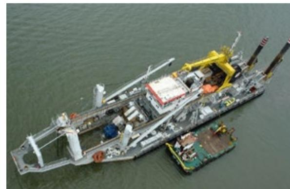
▼ Vista aérea de uma draga de sucção com desagregador mecânico e a presença de uma balsa de apoio a contrabordo. Fonte: Dredging Today.
