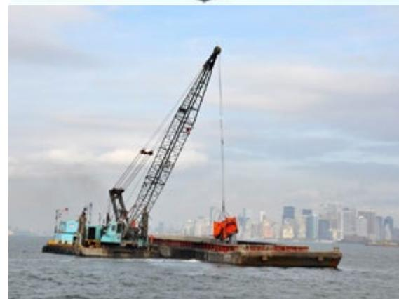
Detalhe da draga com caçamba de mandíbulas / Dragagem de mandíbulas com batelão a contrabordo para o depósito do material dragado. Fonte: shgrab.com
