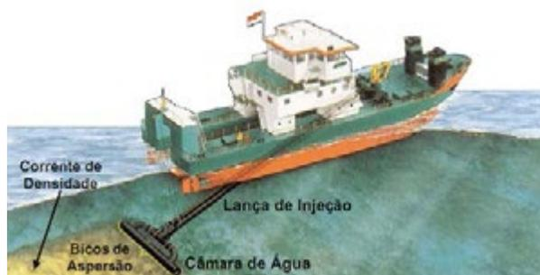
Ilustração do equipamento realizando a dragagem por meio de injeção de água.
