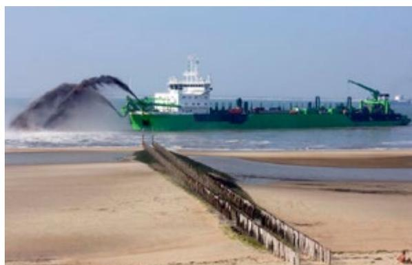
Draga autotransportadora com cisterna realizando o lançamento de sedimentos diretamente no ambiente praiar por meio de cachimbo (rainbow). Fonte: *Dredging International*.
