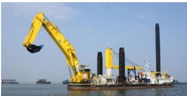
Draga retroescavadeira (backhoe). Detalhe dos três charutos montados na plataforma, dois deles fixados ao substrato para aumento do torque e estabilidade durante a escavação. Fonte: jandenui.com.
