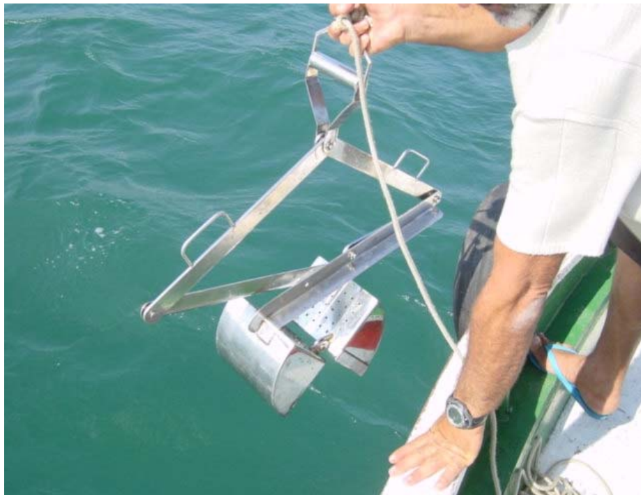
Foto 44 - Lançamento do amostrador de caçamba "van Veen"
