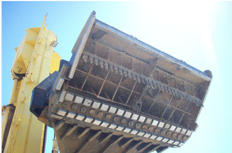
Foto 3: Boca de dragagem de Boreste.
