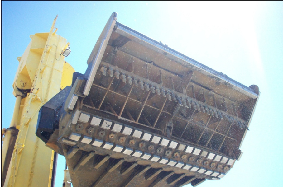
Foto 3: Boca de dragagem de Boreste.
