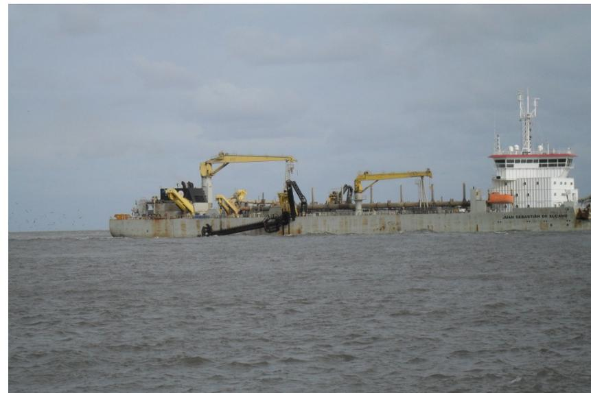
**Foto 2:** Embarcação recolhendo o sistema de dragagem de boreste.
