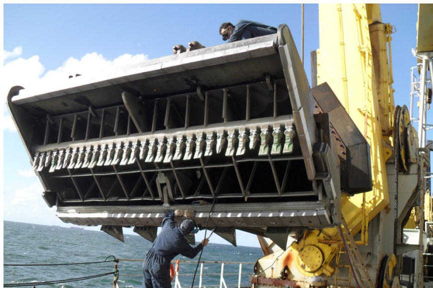
Foto II.7: Realização de modificações no boca de dragagem.
