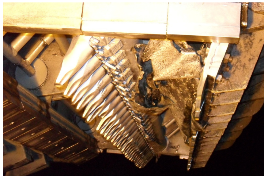
Foto II.10: Resíduo metálico recolhido durante as operações de dragagem preso a boca de dragagem.
