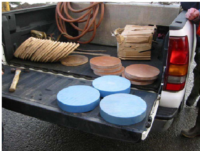
FIGURA PD3 (1): Exemplos de Amortecedores de Cravação de Estacas (Laughlin (2006a))
