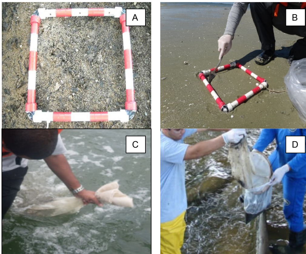
Figura 7.4 - Metodologia de coleta: A – Quadro de 25 x 25cm, B – Coleta a 10cm de profundidade, C – Peneiramento utilizando saco de triagem com malha de 500 µm e D – Transferência do material coletado para o saco devidamente etiquetado
