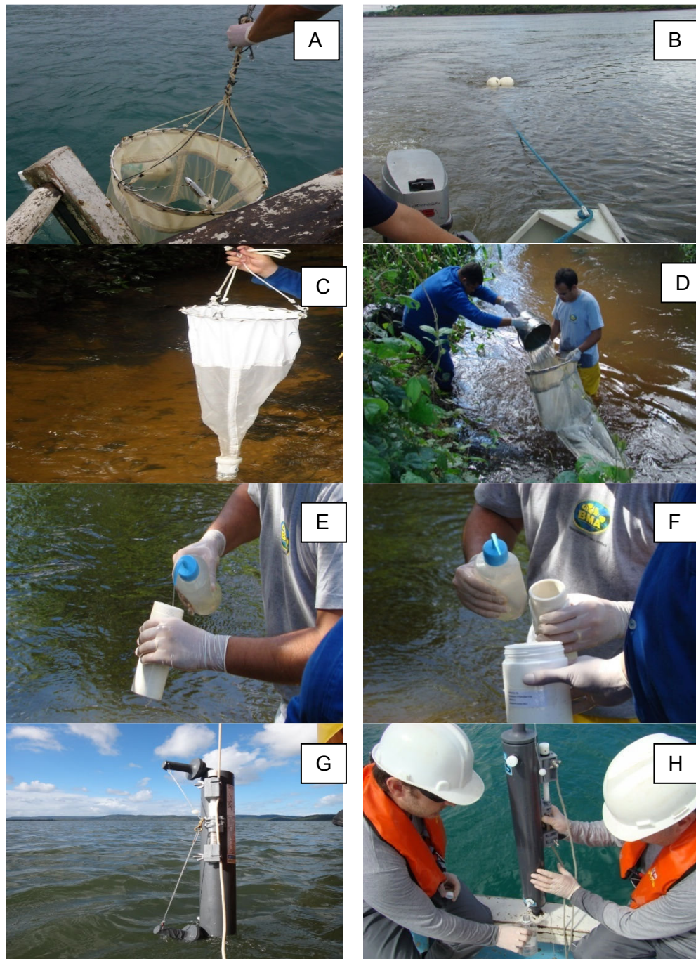
Figura 3.4 - Metodologia de coleta: A – Rede de Plâncton com fluxômetro, B- Arrasto horizontal, C - Rede de Plâncton com malha de 20 µm, D - lançamento de 20 baldes de 10 L na rede de plâncton, E – Lavagem para garantir a coleta de todo material capturado, F – Transferência do material coletado para frasco de 1L devidamente etiquetado, G – Garrafa Coletora de Niskin e H – Transferência da água coletada direto para o recipiente devidamente identificado
