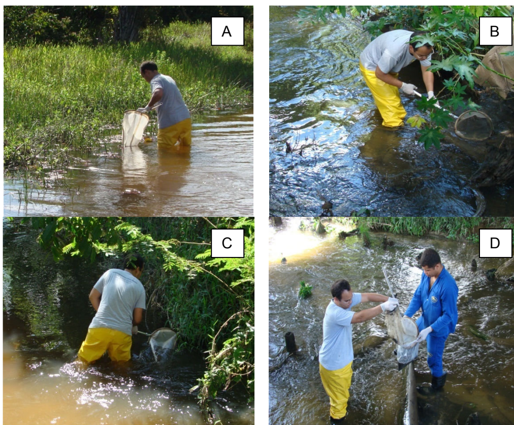
Figura 7.3 - Metodologia de coleta: A, B e C – Coleta utilizando a rede de ISO tipo D de 500 \mu\text{m} e D – Transferência do material coletado para o saco devidamente etiquetado
