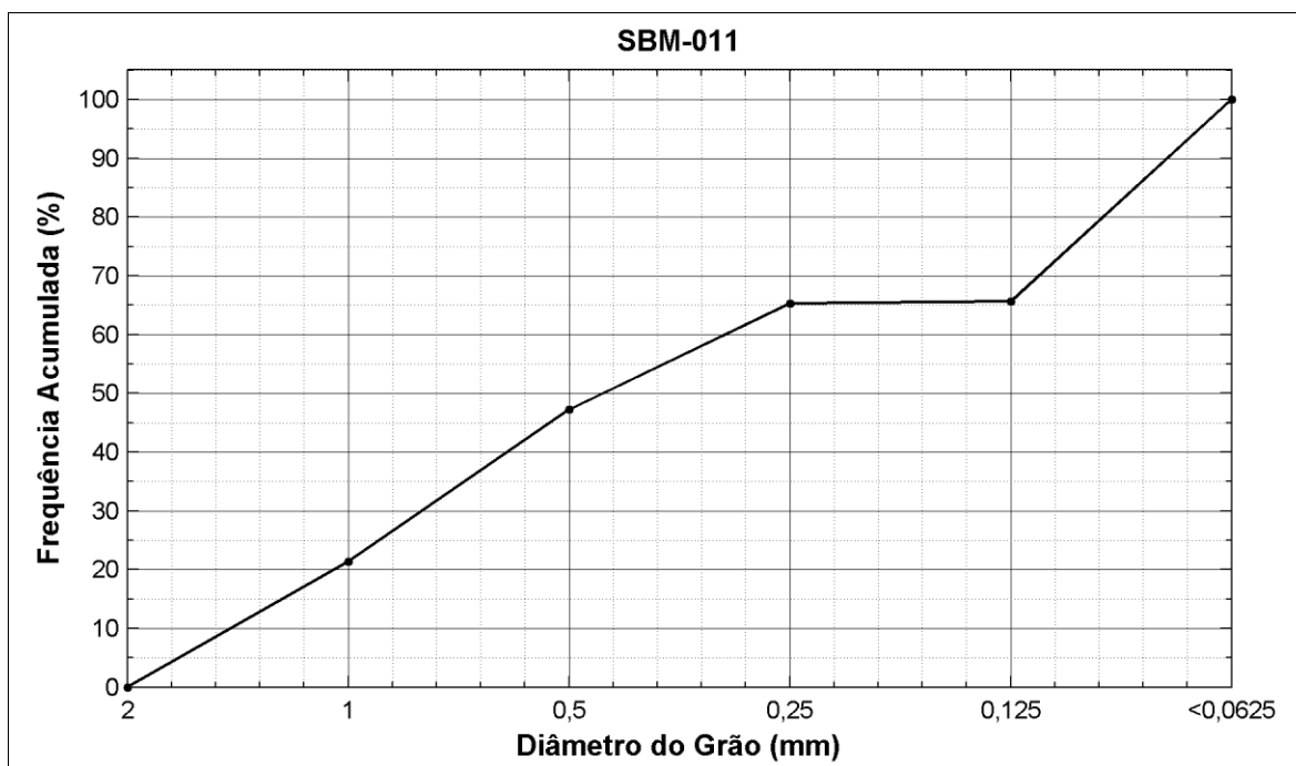
Figura 112: Distribuição de frequência acumulada da amostra SBM-11.
