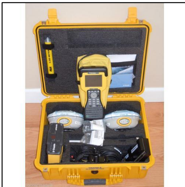
Figura 8: Sistema de posicionamento Trimble R6 RTK.
