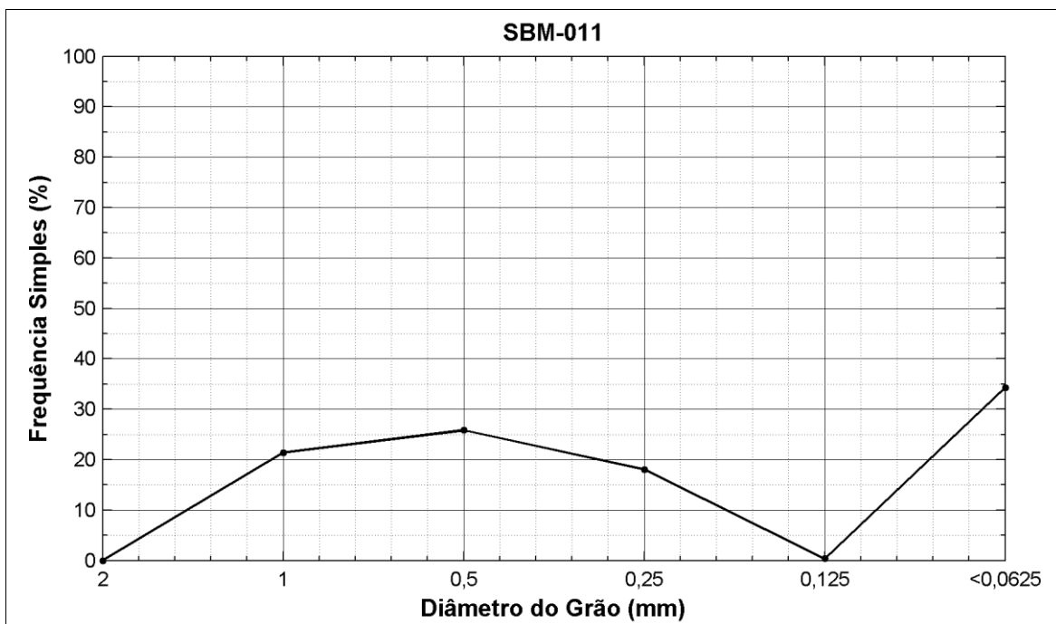
Figura 111: Distribuição de frequência simples da amostra SBM-11
