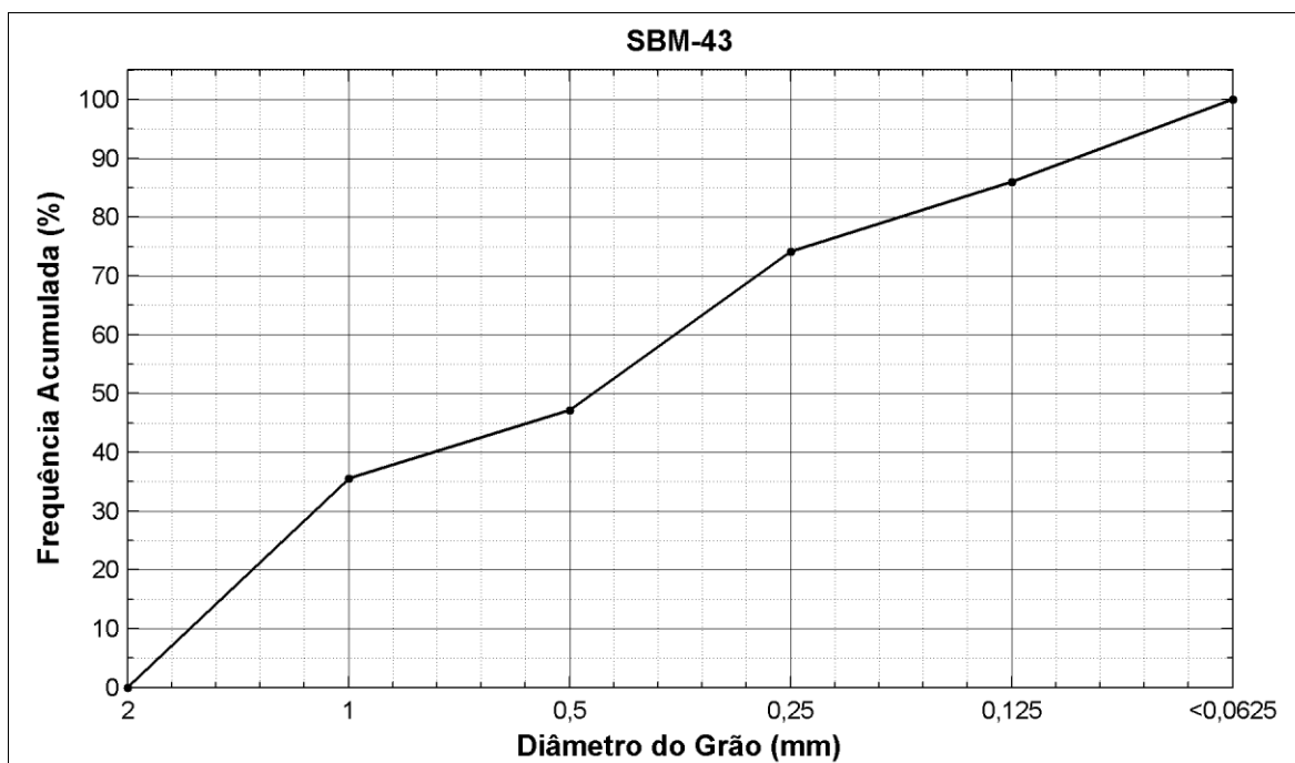
Figura 144: Distribuição de frequência acumulada da amostra SBM-43.
