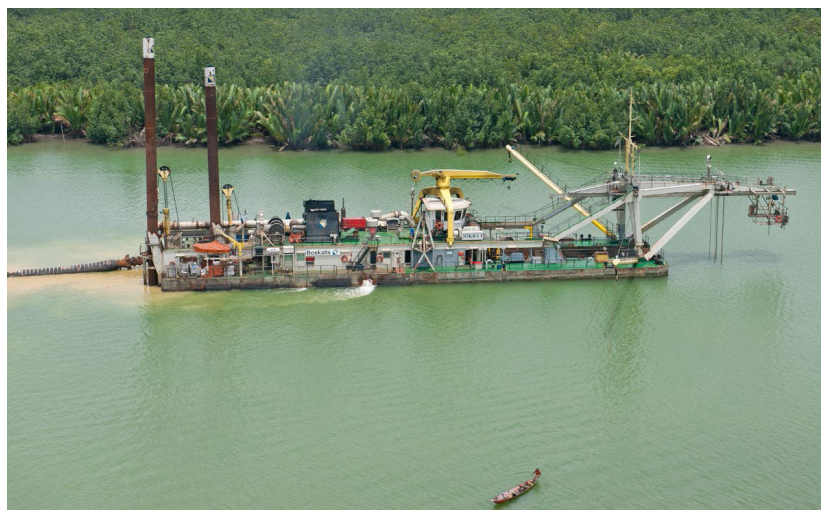
Figura 4.15 - Operação de draga, com tubo de sucção e recalque
