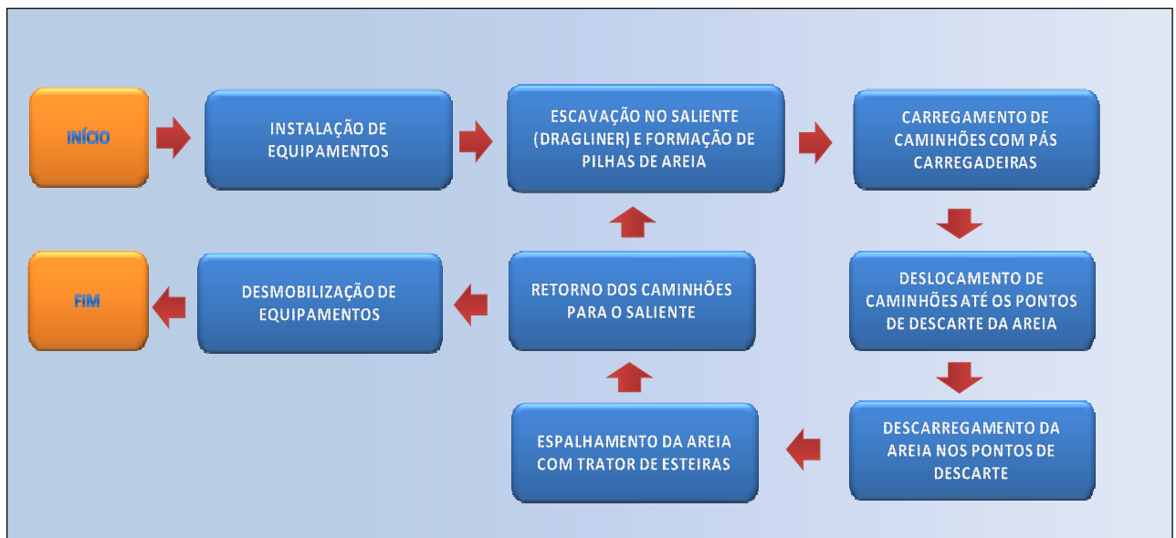
Figura. 5.1 - Ciclo produtivo do sistema de transpasse com caminhões
