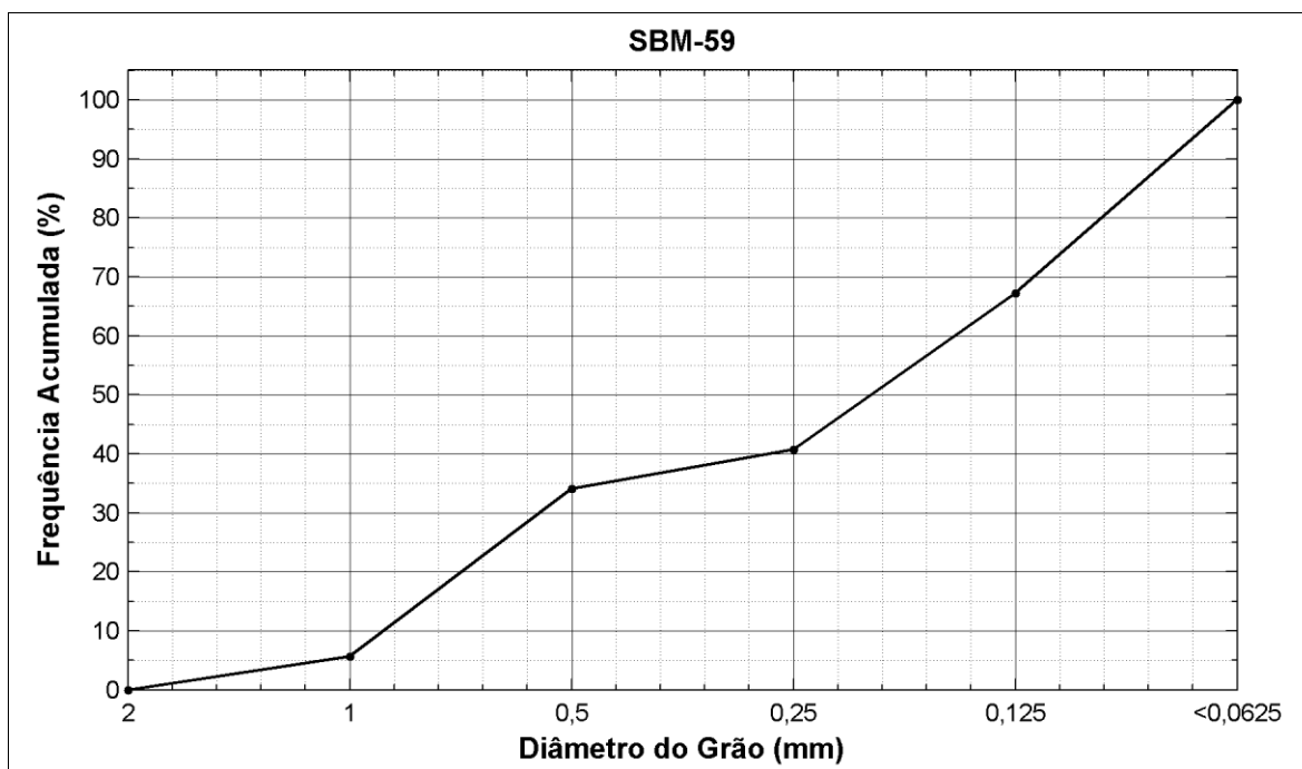
Figura 160: Distribuição de frequência acumulada da amostra SBM-59.
