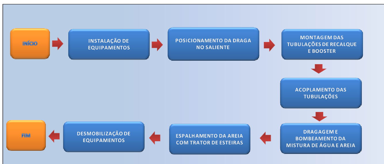
Figura. 5.2 - Ciclo produtivo sistema de transpasse com draga
