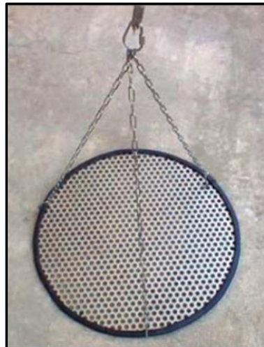
Figura 10: Disco de aferição do transdutor do ecobatímetro (bar check).
