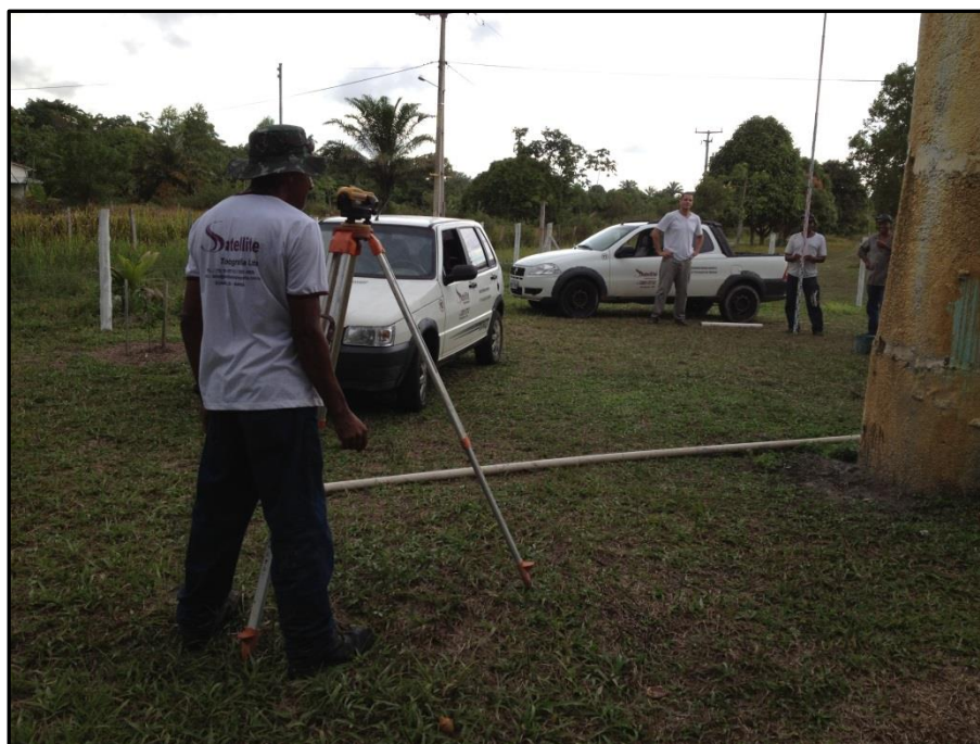
Figura 5: Procedimento de coleta das coordenadas altimétricas.
