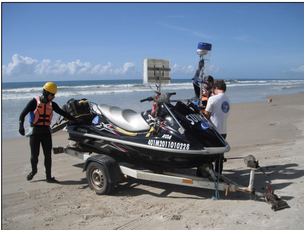
Figura 15: Preparação da moto aquática para coleta de dados batimétricos.
