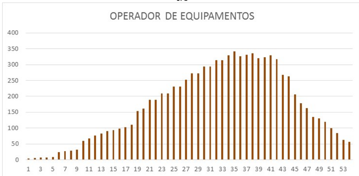
Histograma de permanência de mão de obra para a implantação do empreendimento – operador de equipamentos - Total
