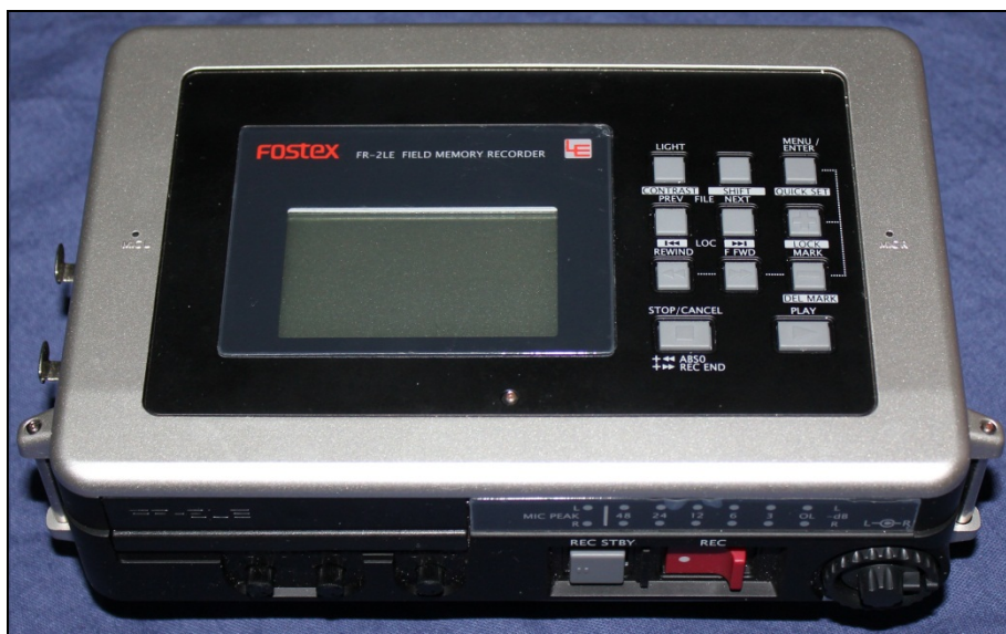
Figura 3.6-Gravador Fostex modelo FR-2LE utilizado na captura de sons provenientes de cetáceos e das embarcações que navegam nas áreas de influência do empreendimento
