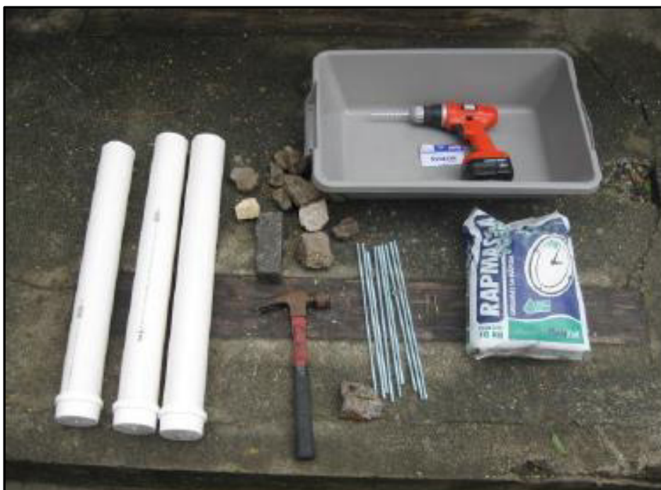
Figura 2: Materiais utilizados para construção dos marcos topográficos.
