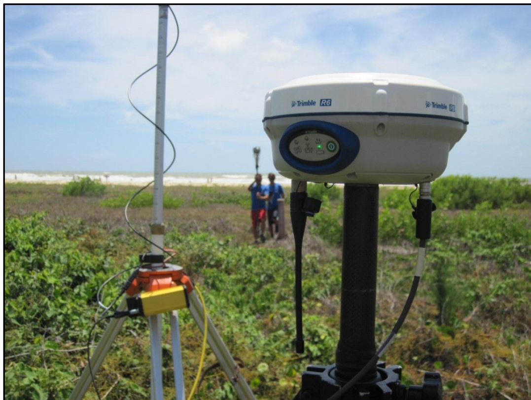
Figura 12: Base fixa do DGPS-RTK e Rádio base instalados; e coleta de dados de perfil na face da praia.
