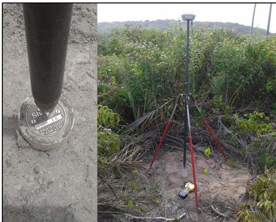
Figura 3: Coleta das coordenadas planimétricas adotando como ponto de posicionamento do equipamento o centro da placa de identificação do marco.
