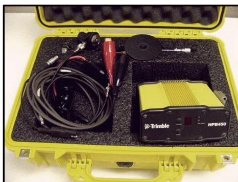
Figura 9: Radio base Trimble HPB 450 usado no sistema Trimble R6 RTK.
