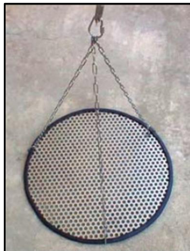
Figura 10: Disco de aferição do transdutor do ecobatímetro (bar check).
