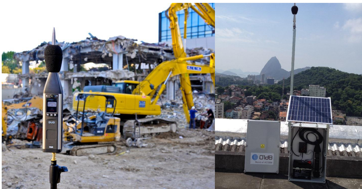
Figura 4.11 - Exemplos de Estações de Monitoramento de Ruído: normal (esquerda) e com gabinete com painel solar (direita)
