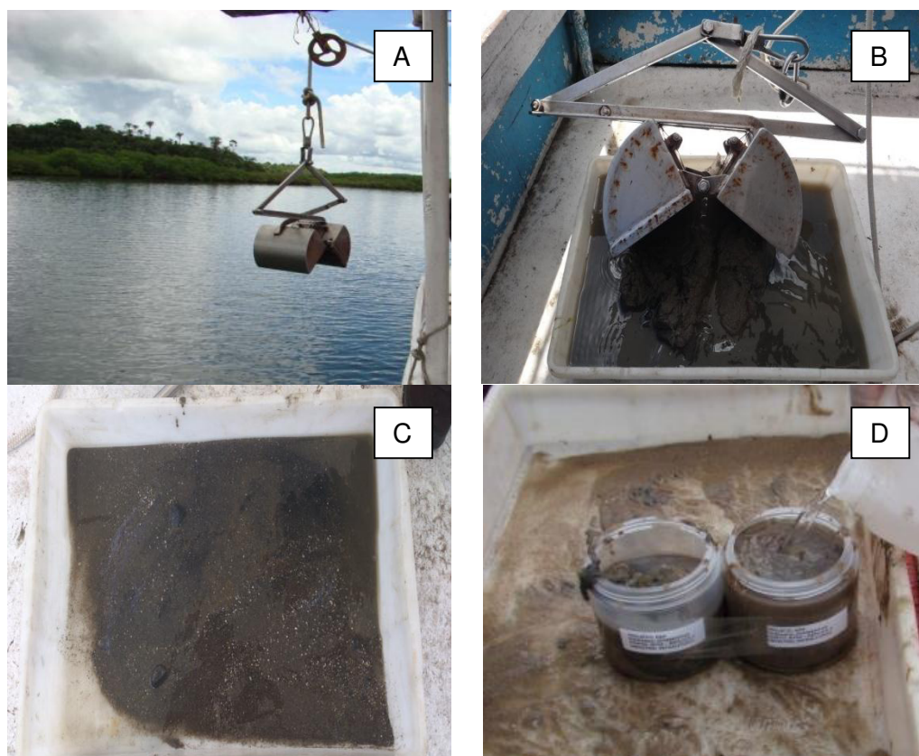
Figura 4.9 - Metodologia de coleta: A – Coleta utilizando a draga tipo van-Veen, B e C - Transferência do material coletado para bandejas plásticas e D - Transferência do material triado para os potes plásticos devidamente etiquetados e preservados em álcool 70% diluído com água do mar
