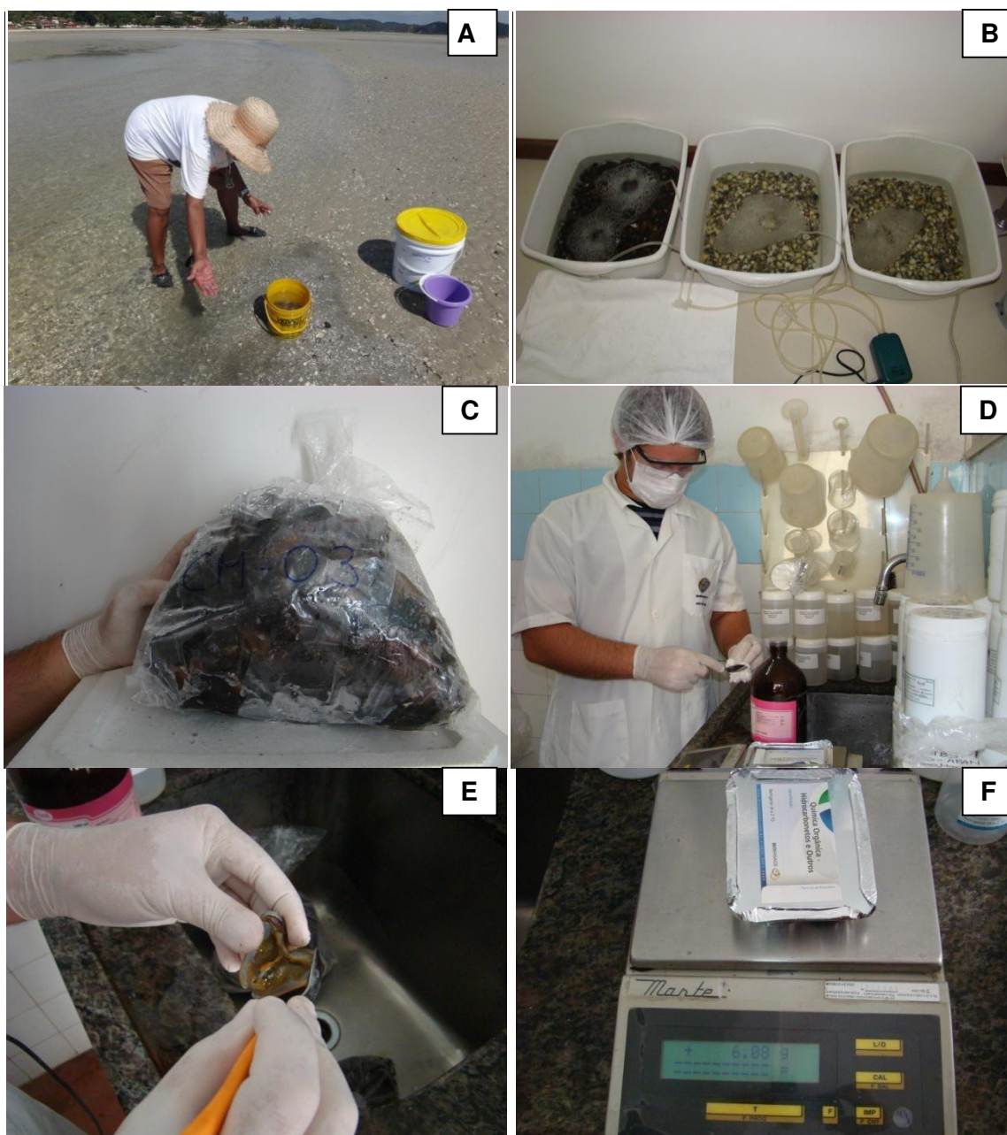
Figura 8.2 - A - Coleta de organismos por profissional da região; B - Desintoxicação de moluscos; C - Acondicionamento das amostras; D - Processamento dos organismos em laboratório; E - Remoção das partes moles, e F - Amostras em balança de precisão
