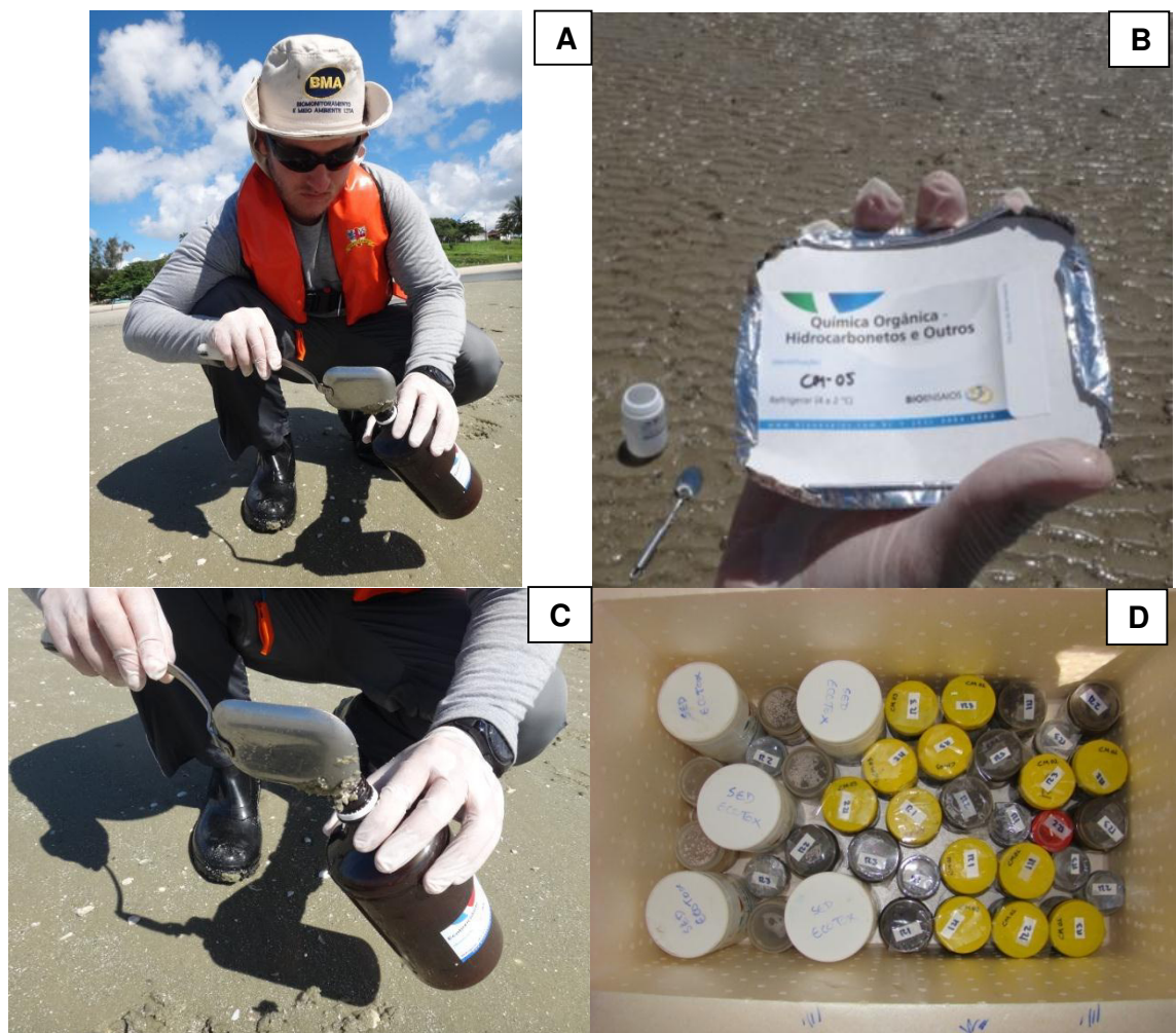
Figura 8.3 - A, B, C - Coleta de sedimento para análises de contaminantes e D – Acondicionamento das amostras
