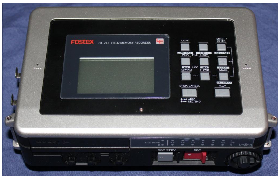
Figura 5.6 - Gravador Fostex modelo FR-2LE utilizado na captura de sons provenientes de cetáceos e das embarcações que navegam nas áreas de influência do empreendimento
