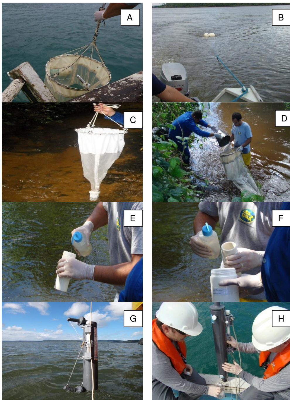
Figura 3.2 - Metodologia de coleta: A – Rede de Plâncton com fluxômetro, B- Arrasto horizontal, C - Rede de Plâncton com malha de 20 µm, D - lançamento de 20 baldes de 10 L na rede de plâncton, E – Lavagem para garantir a coleta de todo material capturado, F – Transferência do material coletado para frasco de 1L devidamente etiquetado, G – Garrafa Coletora de Niskin e H – Transferência da água coletada direto para o recipiente devidamente identificado
