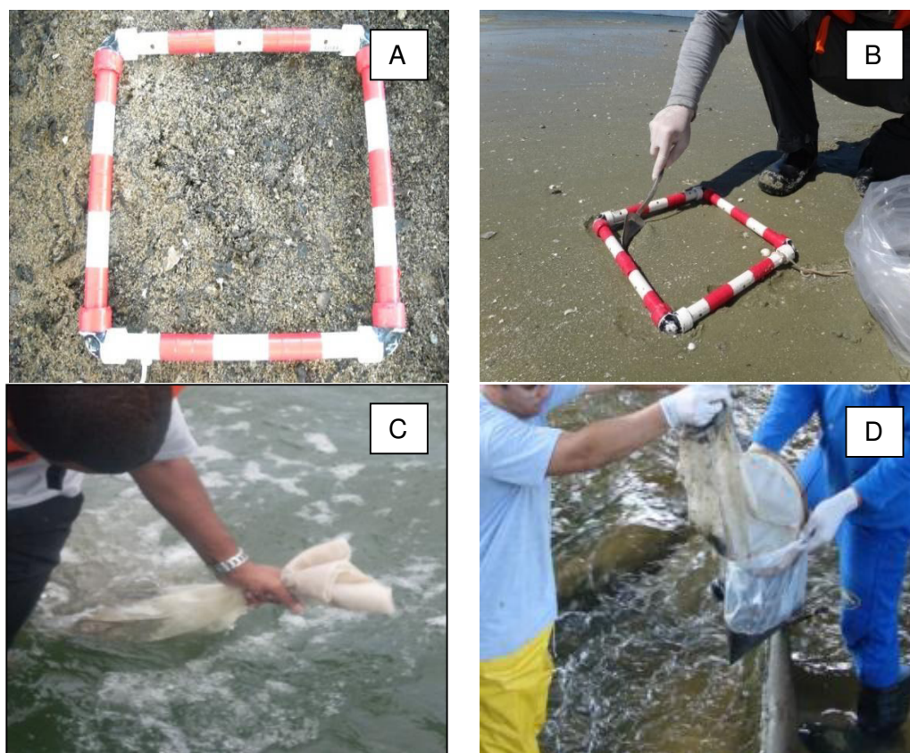
Figura 4.3 - Metodologia de coleta: A – Quadro de 25 x 25cm, B – Coleta a 10cm de profundidade, C – Peneiramento utilizando saco de triagem com malha de 500 µm e D – Transferência do material coletado para o saco devidamente etiquetado
