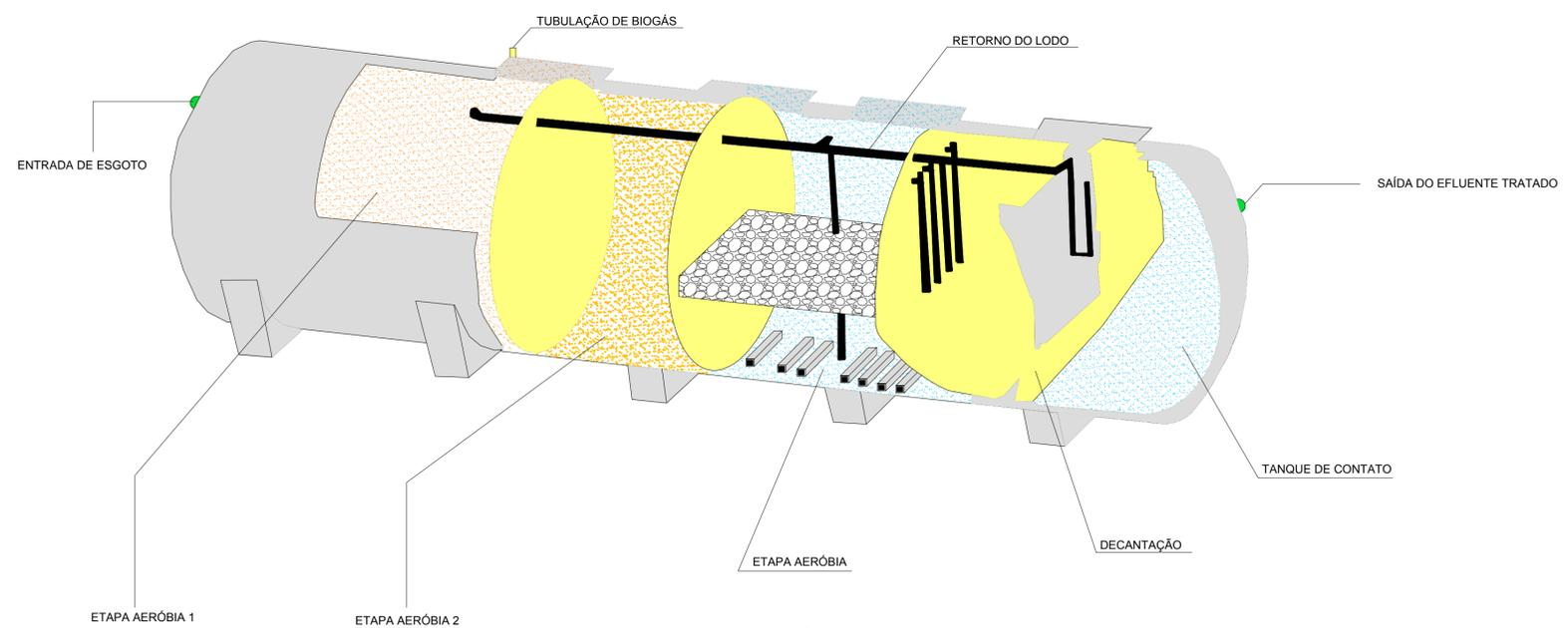
2 DETALHE DA ESTAÇÃO DE TRATAMENTO DE ESGOTO
