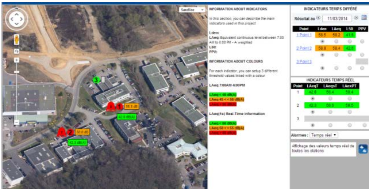
Figura 4.12- Exemplo de WebMonitoring: visualização dos níveis de ruído em tempo real para três EMRs
