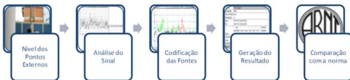
Figura 2 - Representação do processo de medição de ruído ambiental e análise.
