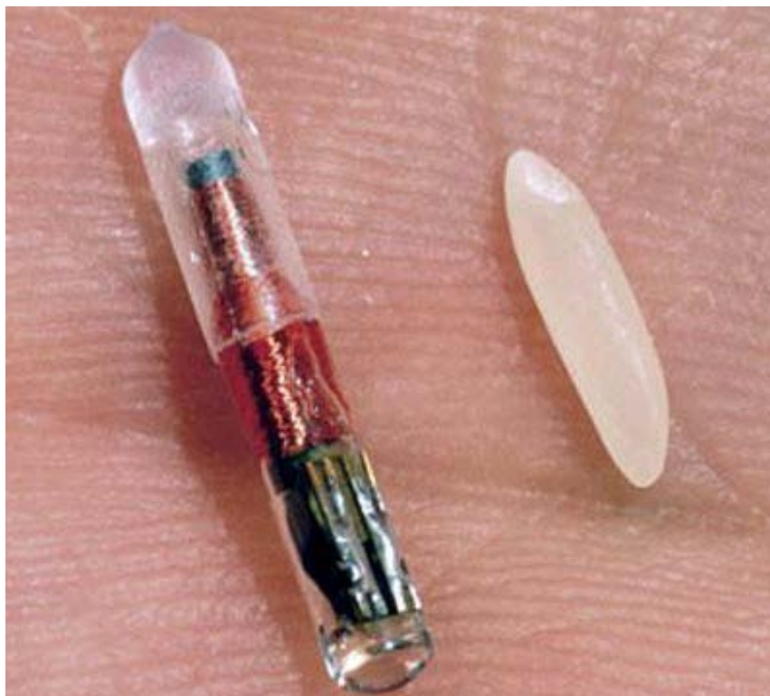
Figura 3.26 -Modelo de microchip de aplicação subcutânea utilizado na marcação de répteis de médio a grande porte e de mamíferos de médio a grande porte
