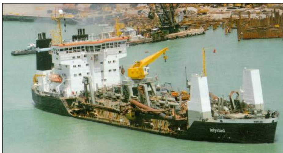
Figura 4-1: Dragagem Autotransportadora (TSHD / Trailer Suction Hopper Dredger ).
