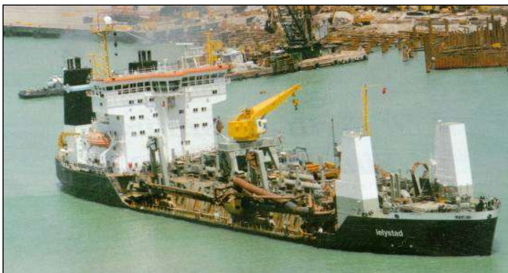
Figure 3.1: Draga de sucção e autotransporte (TSHD)
