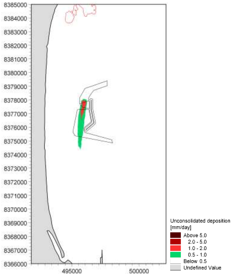
Figura 5.7: Taxa de deposição diária de material inconsolidado durante uma corrente típica para o sul. Dragagem do canal de navegação - C.
