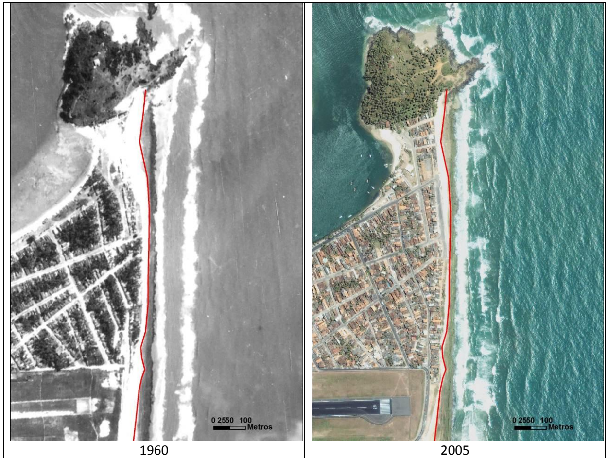
Figura 8.1.6.2.12 - Setor I.S. Neste Setor a Linha de Costa Permaneceu Estável Experimentando Pequenas Oscilações como Mostram as Fotos Acima. A linha Vermelha Corresponde à Linha de Costa de 1960 Vizinhanças do Transecto 291
