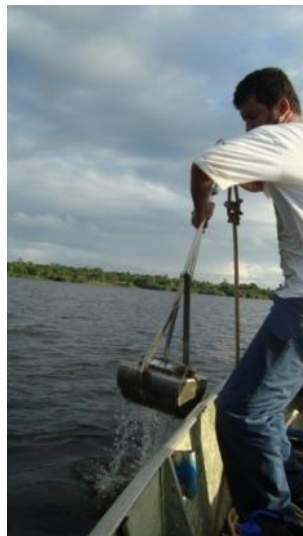
Obs. Exemplo de Amostragem da Campanha 1 de 2010 Figura 8.1.1.4.90 - Amostragem de Sedimento Amostrador de Fundo Petersen
