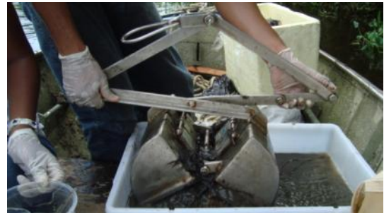
Obs. Exemplo de Amostragem da Campanha 1 de 2010 Figura 8.1.1.4.91 - Abertura do Pegador de Fundo Petersen
