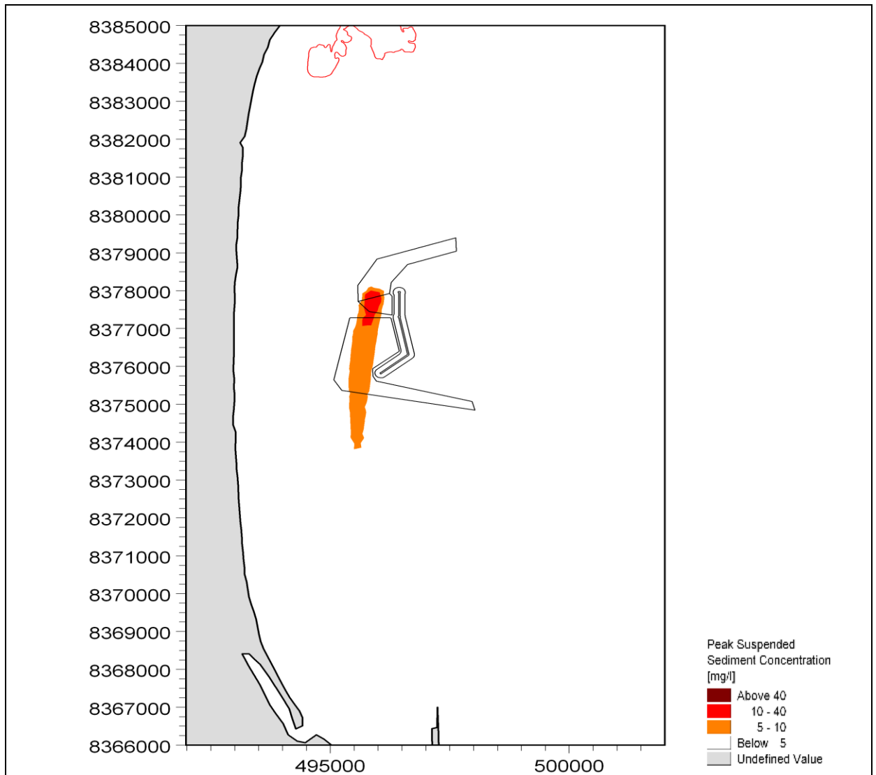
Figura 8.1.8.3.7 - Concentrações Máximas de Sedimento Durante uma Corrente Típica para o Sul. Dragagem do Canal de Navegação - C
