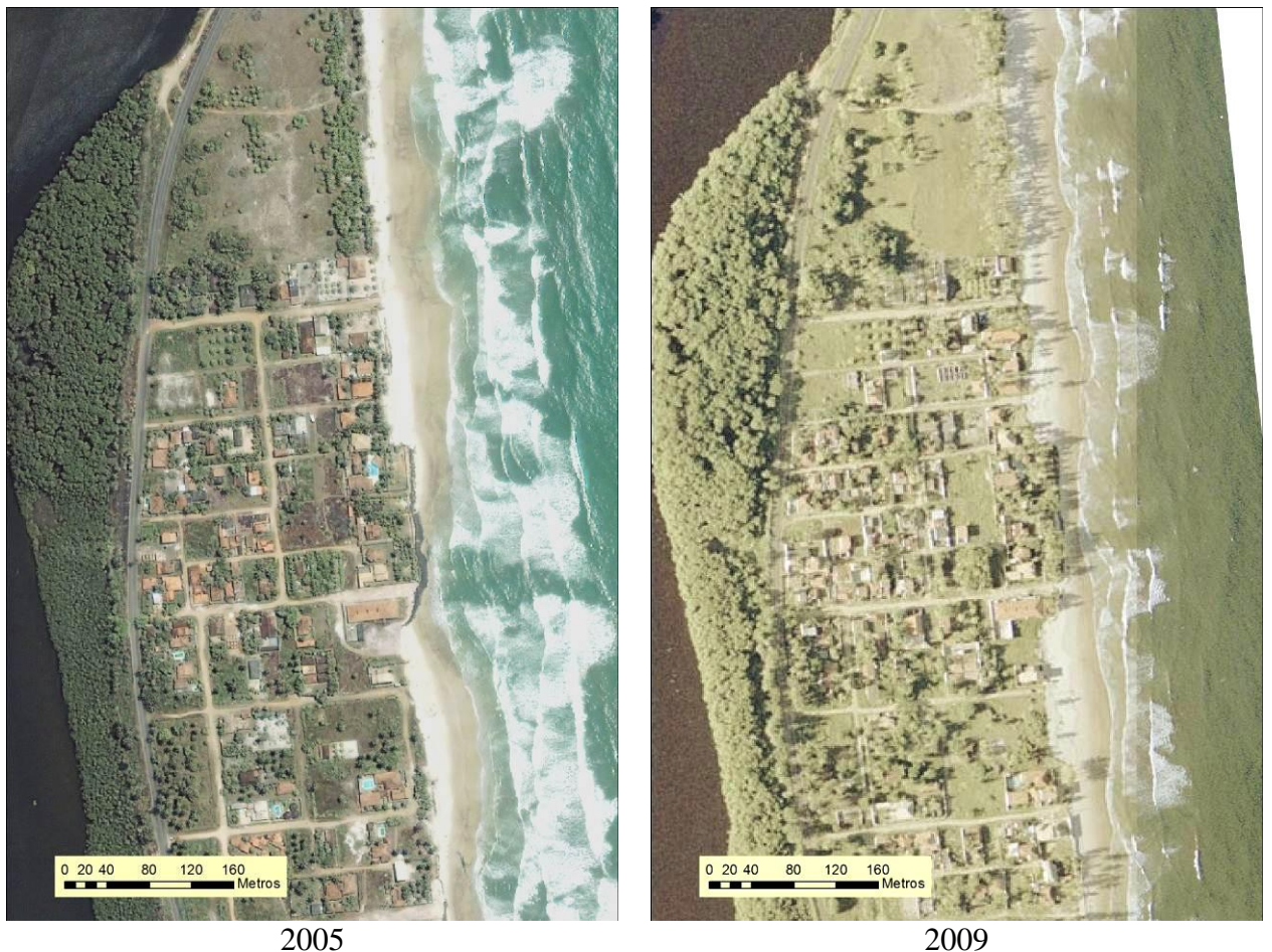
Figura 8.1.6.2.24 - Comparação entre as Fotos de 2005 e 2009, Mostrando que a Erosão Continua a Despeito da Construção dos Molhes
