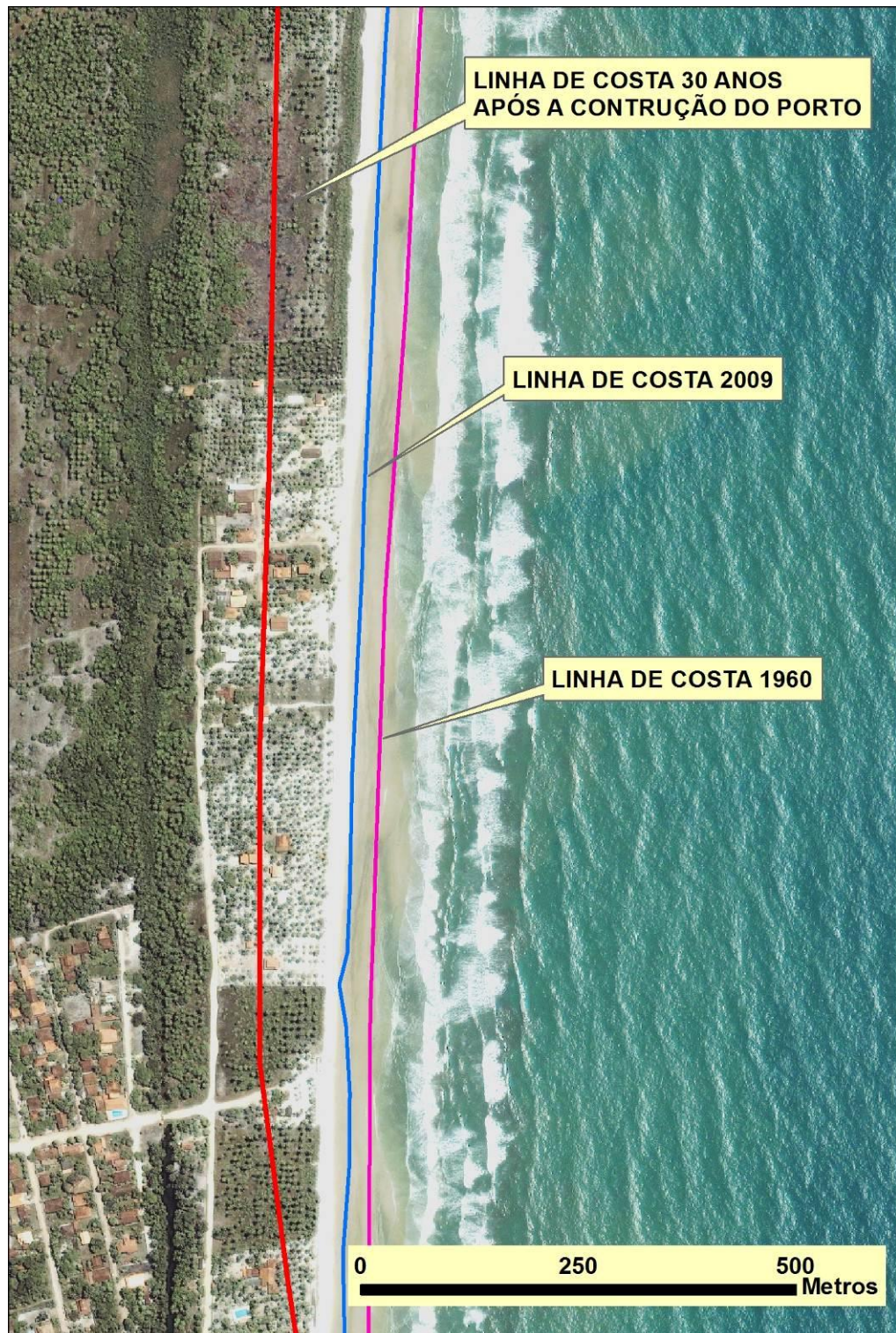
Figura 8.1.6.2.21 - Previsão da Posição da Linha de Costa Imediatamente a Norte do Saliente 30 anos após a Construção do Porto de Aritaguá, Segundo Resultados da Modelagem Realizada pela Scott-Wilson. Esta Erosão, em Magnitude Decrescente, muito Provavelmente se Estenderá por mais de uma Dezena de Quilômetros, a Norte
