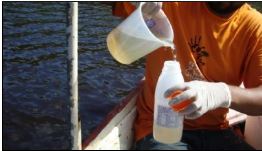
Figura 8.1.1.4.83 - Amostragem de Água Superficial e Armazenamento em Garrafa Adequada para Cada Parâmetro
