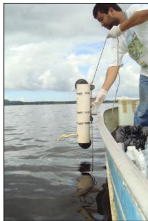
Figura 8.1.1.4.85 - Garrafa de Van Dorn para Amostragem de Fundo da Lagoa Encantada
