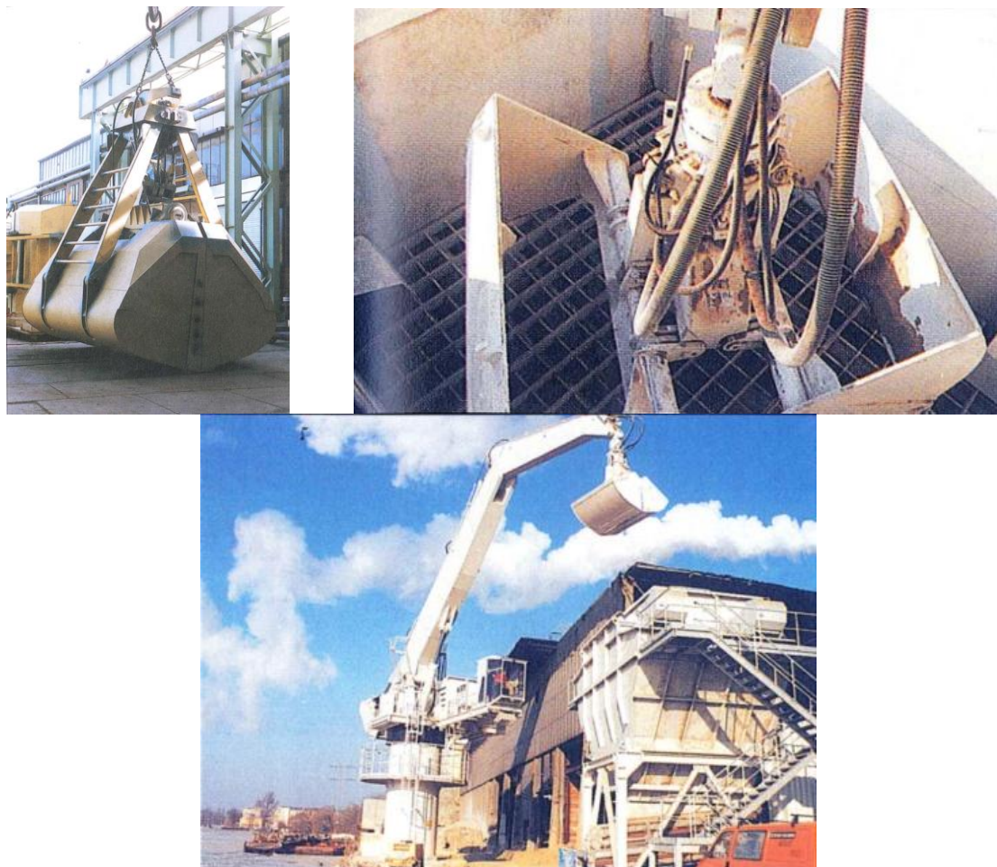
Figura 5.30 - Ilustrações do Descarregador do Tipo grab
