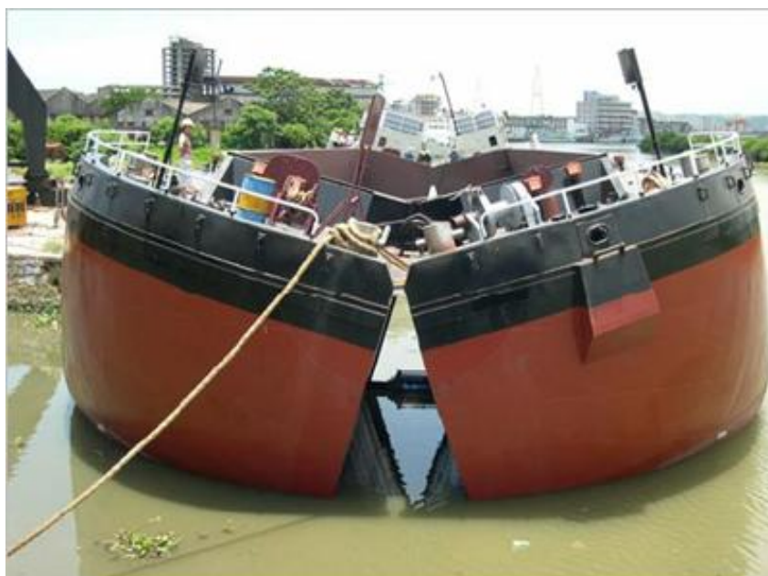
Figura 5.69 - Exemplo de Barçaça Split Hopper Barge
