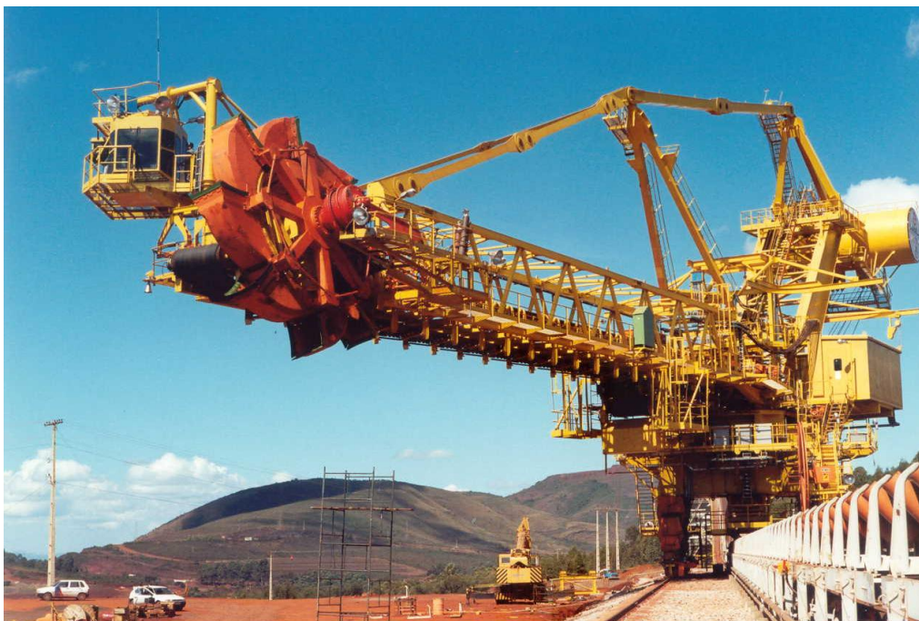
Figura 5.21 - Retomadora de Lança com Roda de Caçambas
