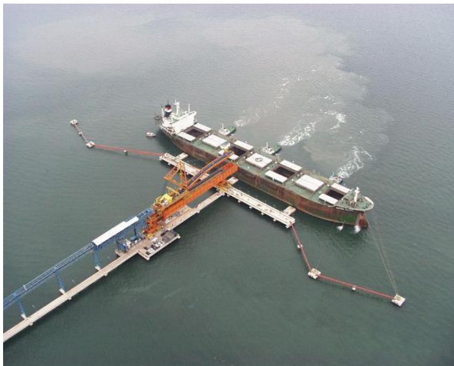
Figura 5.24 - Ilustração de Carregamento de Navio por Meio de Equipamento do Tipo Dual Liner
