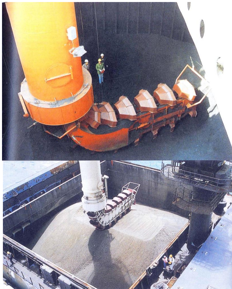
Figura 5.31 - Ilustração de Descarregador de Navio do Tipo Shipunloader
