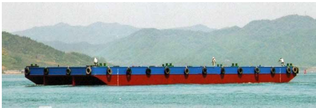
Figura 5.70 - Exemplo de Barcaça Flat-topped Rock Barge
