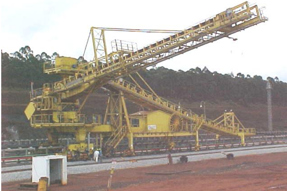
Figura 5.19 - Empilhadeira de Lança Basculável e Giratória
