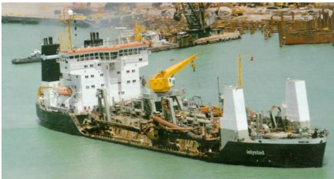
Figura 5.54 - Exemplo de Dragagem do Tipo TSHD com Capacidade de 10.000 m 3
