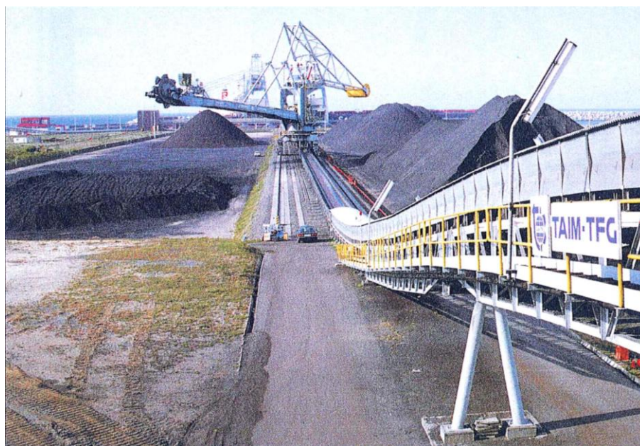
Figura 5.23 - Ilustração da Operacionalização de um Pátio de Estocagem de Minério de Ferro
