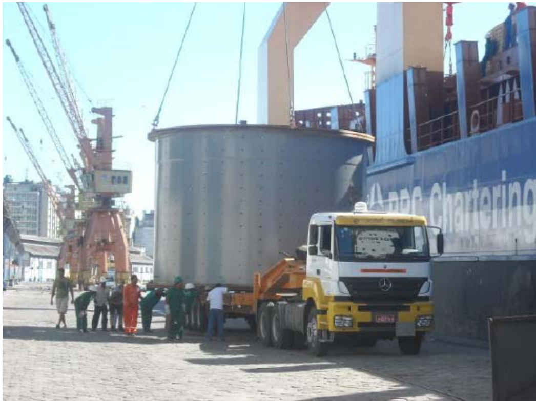
Figura 1 - Peça de 6,5 Metros de Diâmetro e 4,5 metros de Altura Descarregada no Porto de Salvador e Transportada para o EADI Salvador e para Itagibá, no Interior da Bahia
