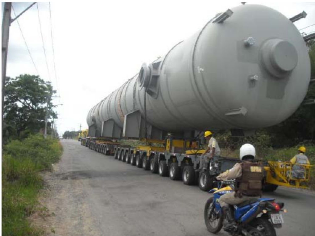
Figura 2 - Reator Descarregado na Base Naval de Aratu e Transportado para Camaçari (BA). Utilizou Linhas de Eixo e dois Cavalos na Dianteira por Causa dos Aclives e Declives da Pista. Peça com 380 Toneladas
