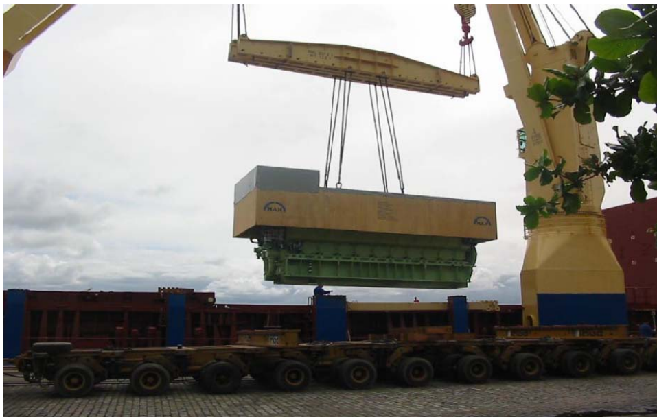
Figura 4 - Detalhe da Descarga do Motor na Base Naval de Aratu, em Salvador, com Guindastes de Bordo do Navio, o qual foi Transportado para Camaçari - BA
