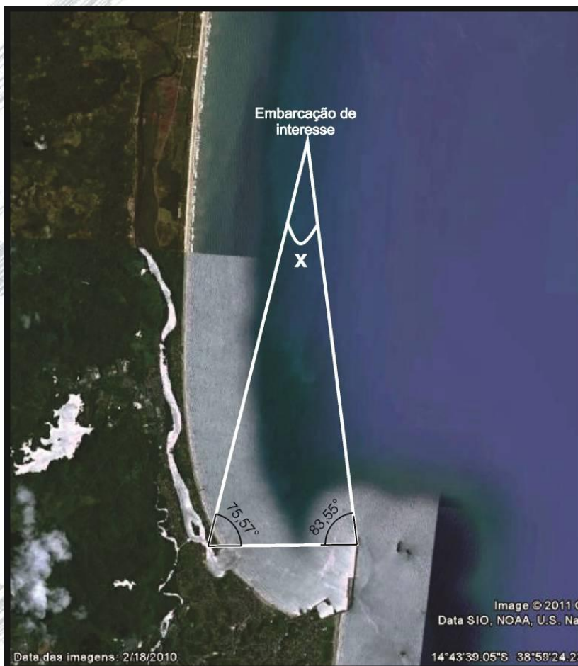
Figura 02 – Método “intersecção avante” utilizado para identificação das rotas das embarcações.
