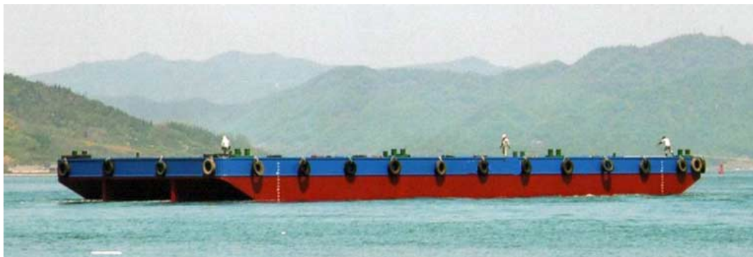
Figura 6.11 - Figura 5.70 - Exemplo de Barcaça Flat-topped Rock Barge
