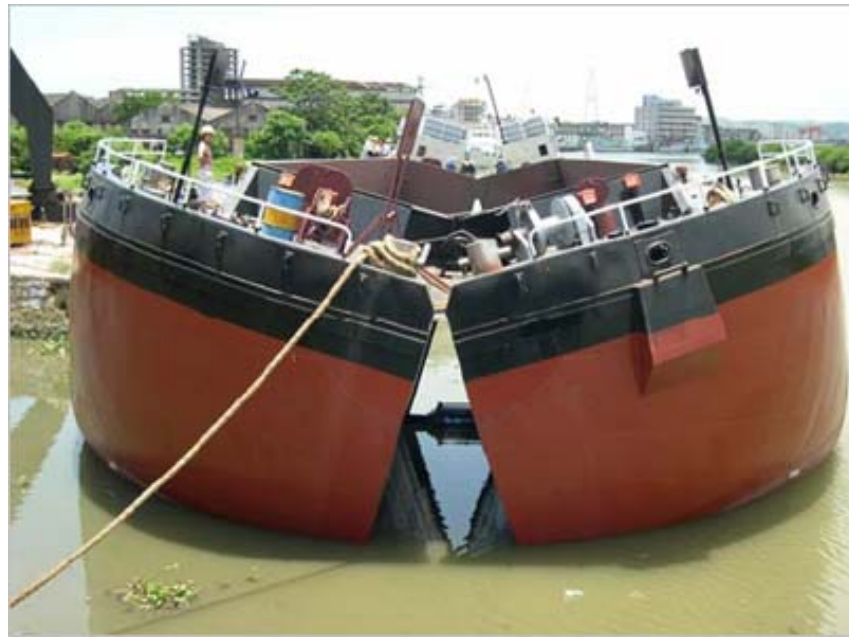
Figura 6.10 - Figura 5.69 - Exemplo de Barcaça Split Hopper Barge
