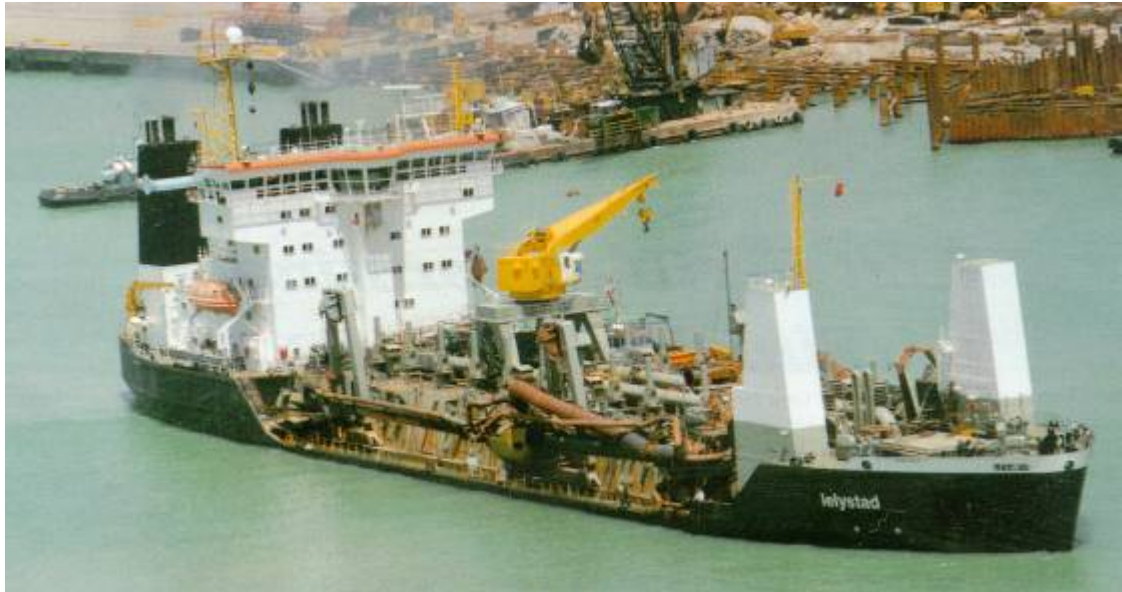
Figura 5.1 - Figura 5.54 - Exemplo de Draga do Tipo TSHD com Capacidade de 10.000 m 3
