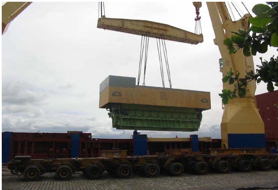
Figura 4 - Detalhe da Descarga do Motor na Base Naval de Aratu, em Salvador, com Guindastes de Bordo do Navio, o qual foi Transportado para Camaçari - BA
