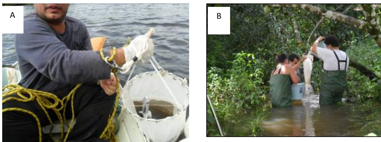
Figura 2.15 - Representação do Processo de Amostragem do Plâncton Utilizando (A) Arrasto Horizontal Superficial e (B) Filtragem 200 L Diretamente na Rede de Arrasto Cônica. Porto Sul - BA (maio/2011 e setembro/2011)
