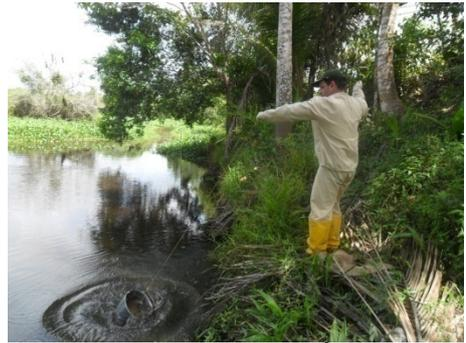
**Figura 1.136 - Amostragem de Água Superficial com Balde de Aço Inoxidável**
