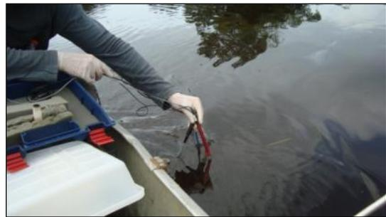
**Figura 1.143 - Medição de pH, Condutividade e Temperatura**
