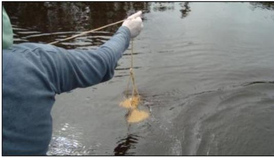
**Figura 1.146 - Detalhe da Inserção do Disco de Secchi em Corpo D'água Exemplo do Rio Almada**
