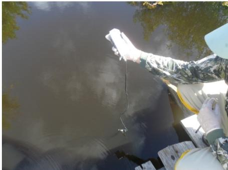
**Figura 1.144 - Medição de Oxigênio Dissolvido na Água**
