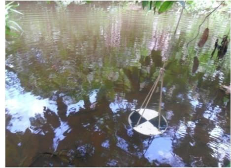
**Figura 1.147 - Detalhe da Inserção do Disco de Secchi em Corpo D'água Exemplo do Rio Itariri**
