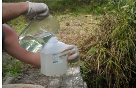
**Figura 1.138 - Amostragem de Água Superficial com Bquer de Vidros e Armazenamento em Garrafa Apropriada**
