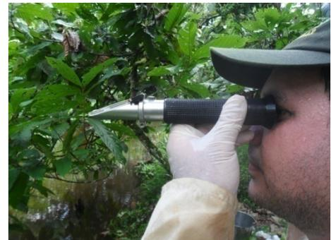
**Figura 1.149 - Medição de Salinidade Através de Refratômetro Exemplo Campanha 2012**
