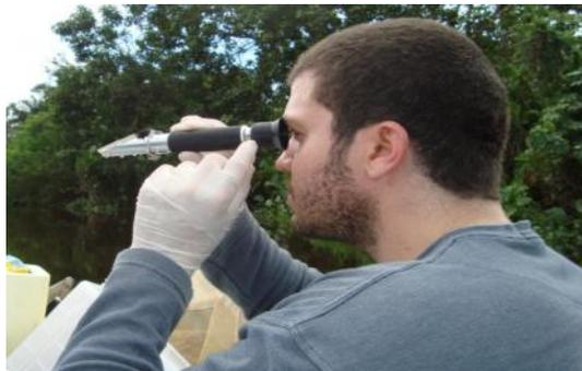
**Figura 1.148 - Medição de Salinidade Através de Refratômetro Exemplo Campanha 2010**
