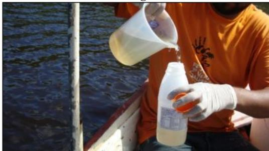
**Figura 1.137 - Amostragem de Água Superficial com Bquer de Plástico e Armazenamento em Garrafa Apropriada**
