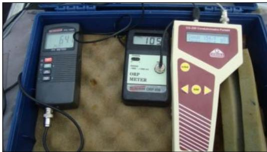
**Figura 1.142 - Equipamentos: ORP (*Oxidation Reduction Potential*), pH (Potencial Hidrogeniônico), Condutividade e Temperatura**
