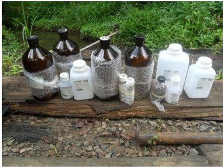
**Figura 1.135 - Garrafas e Frascos Destinados ao Armazenamento e Preservação das Amostras de Água**
