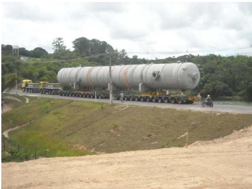
**Figura 3 - Outra Visão da Peça Anterior, com Destaque para os dois Cavalos na Dianteira do Conjunto Transportador**
