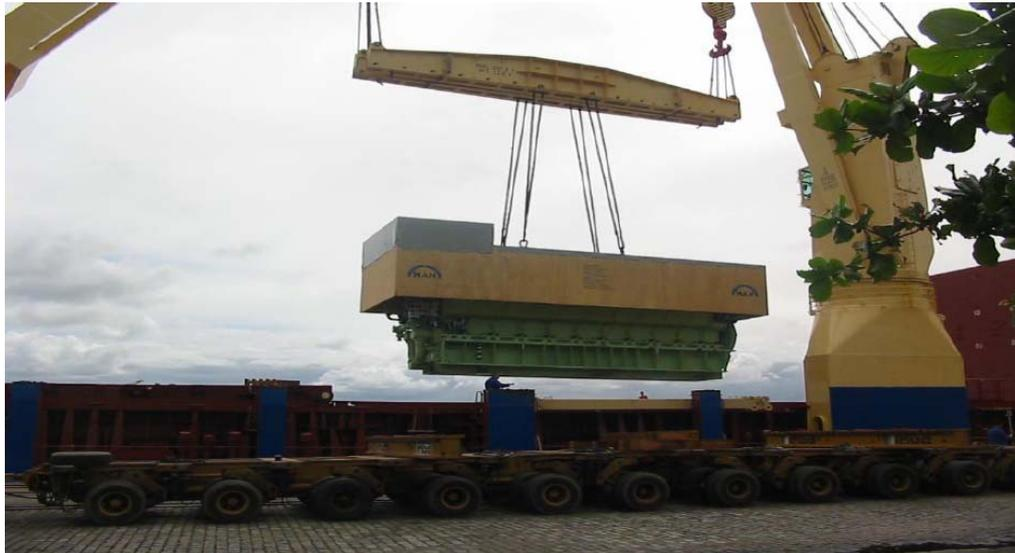
**Figura 4 - Detalhe da Descarga do Motor na Base Naval de Aratu, em Salvador, com Guindastes de Bordo do Navio, o qual foi Transportado para Camaçari (BA)**
