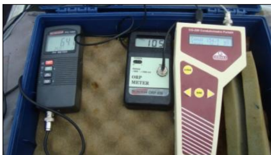
Figura 2.112 - Equipamentos: ORP ( Oxidation Reduction Potential ), pH (Potencial Hidrogeniônico), Condutividade e Temperatura
