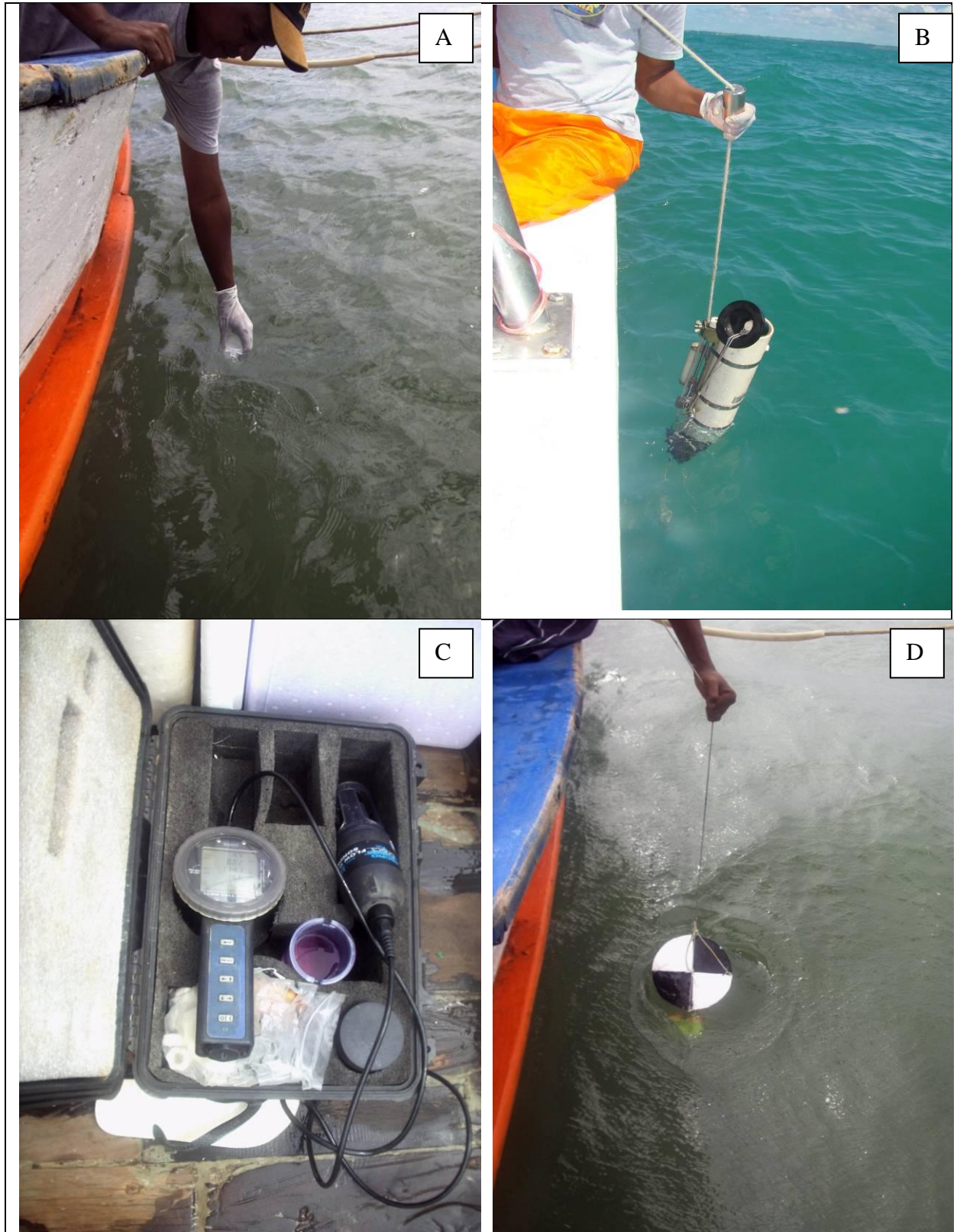
Figura 2.211 - Rotina de Coleta Empregada na Campanha Realizada em Maio e Setembro de 2011. A - Coleta de Amostra Microbiológica; B - Lançamento da Garrafa de Van-Dorn; C - Sonda Multiparamétrica Hidrolab/Quanta e D; Disco de Secchi
