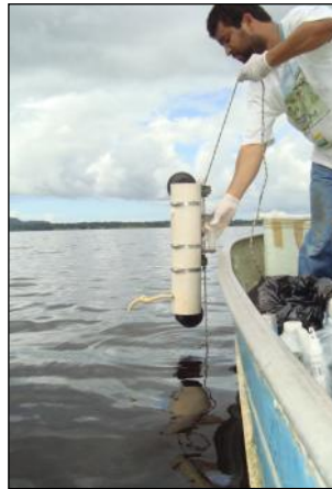
Figura 2.111 - Garrafa de Van Dorn para Amostragem de Fundo da Lagoa Encantada
