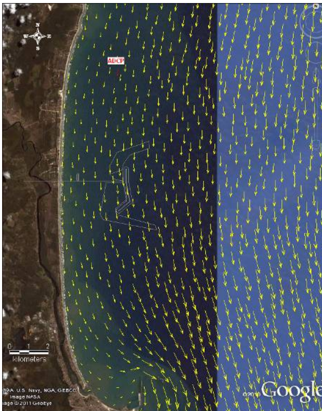
Figura 4.6: Exemplo de resultado do modelo hidrodinâmico para correntes de sul durante o período de validação.
