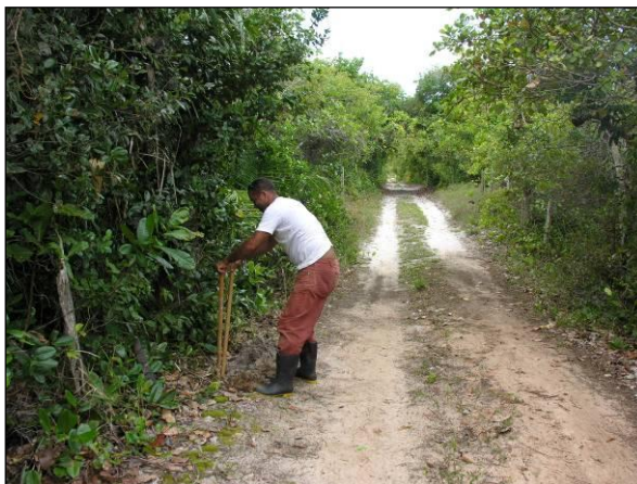
Figura 4.51 - Abertura da Sondagem 07, Próximo da Estrada BA 001, no Interior da Fazenda Alandi
