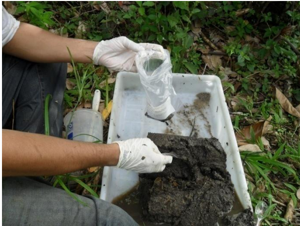
Figura 4.7 - Sedimento Sendo Amostrado
