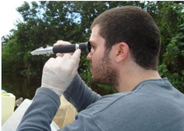
Figura 4.4 - Medição de Salinidade Através de Refratômetro
