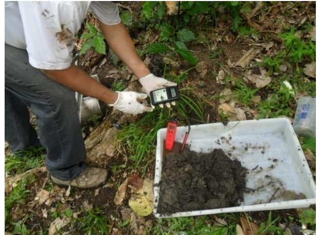
Figura 4.8 - Detalhe da medição de pH e ORP
