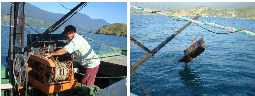
Figura 5.2.2.1-10: Guincho de pesca, estrutura do tangone e portas da rede de arrasto-de-fundo.
