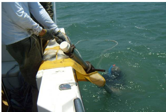
Figura 5.1.6.1.4 - 2: Retirada do tubo de alumínio por um mergulhador contendo o sedimento coletado
