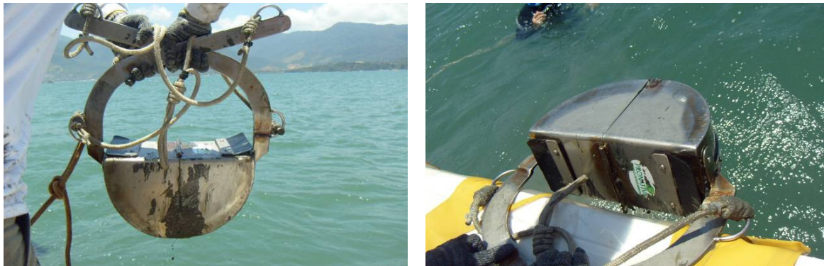
Figura 5.1.6.1.4 - 1: Draga do tipo van Veen utilizada para coleta de sedimento superficial.
