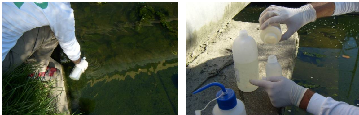
Figura 5.1.7.4.3 - 1: Amostragem de água da camada superficial, através da imersão direta de um frasco sem preservante no corpo de água, com posterior transferência para os frascos contendo preservante.
