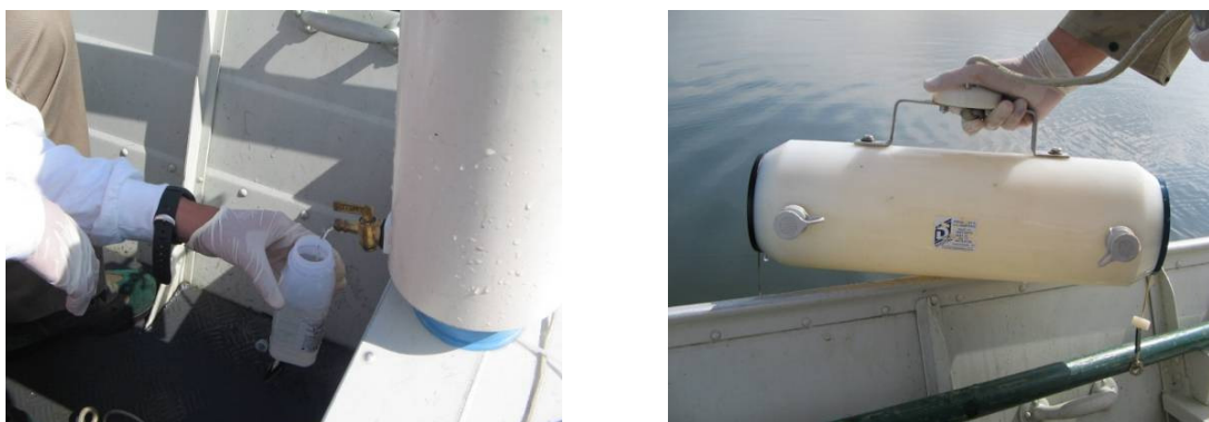
FIGURA 5.1.7.4.3 - 2: GARRAFA DO TIPO VAN DORN UTILIZADA PARA COLETA DE ÁGUA EM SUB-SUPERFICIAL.
