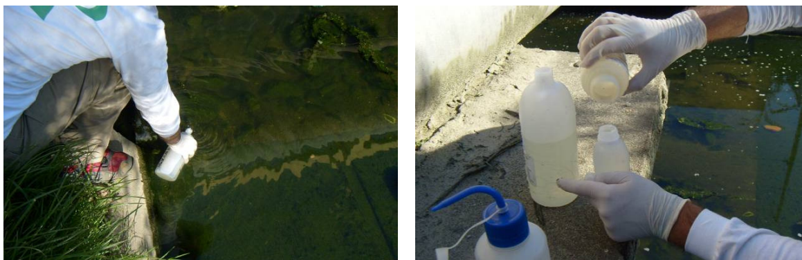
Figura 5.1.7.3.2. - 1: Amostragem de água da camada superficial, através da imersão direta de um frasco sem preservante no corpo de água, com posterior transferência para os frascos contendo preservante.
