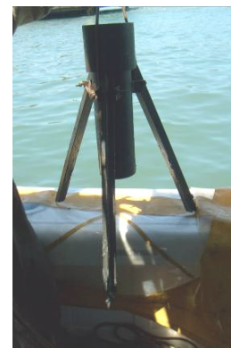
Figura 5.1.6.1.4 - 3: Equipamento utilizado para fixação do tubo de alumínio no sedimento
