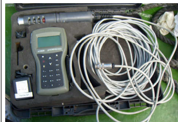
Figura 11 - Sonda multiparamétrica da marca HANNA, utilizada para as medições físico-químicas in situ na água.
