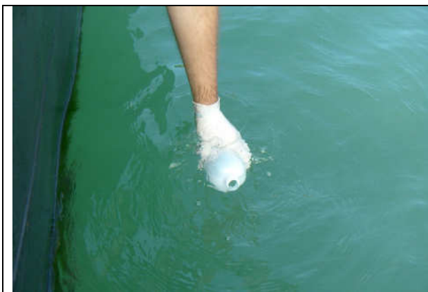
Figura 7 - Amostragem de água superficial, através da imersão direta dos frascos no corpo de água.
