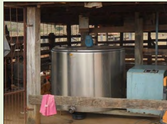
Figura 7.3.1.2.1-168: Resfriadora de Leite.
