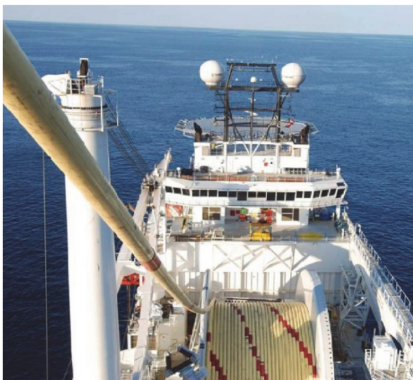
Navio Spool, com sistema de bobinamento
