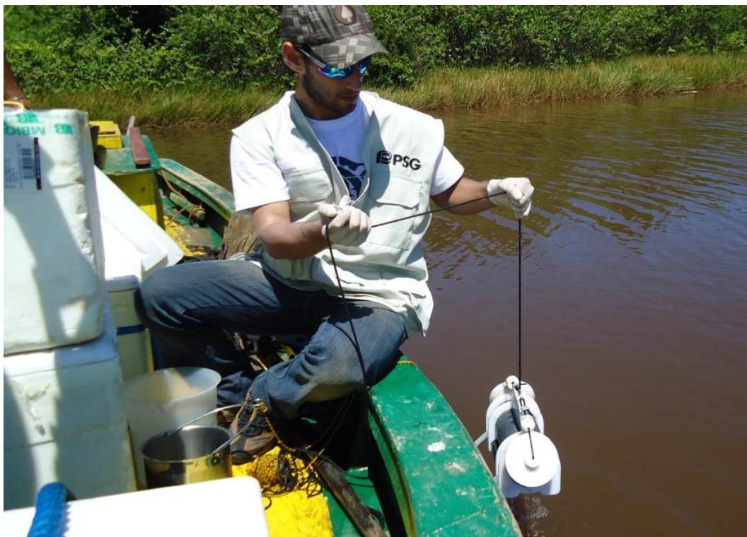
Figura 4.1-68 – Coleta da água com uso da garrafa de Van Dorn
