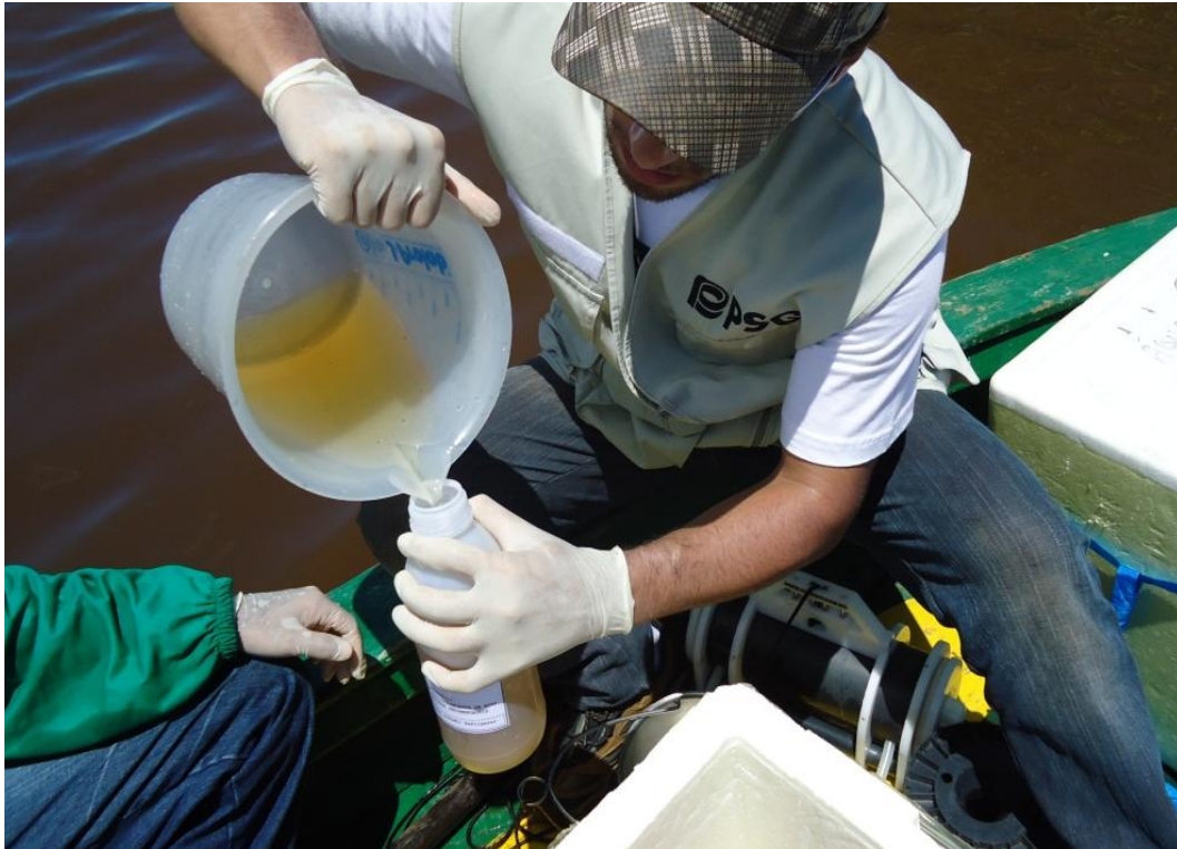
Figura 4.1-69 – Armazenamento de água para posterior análise laboratorial
