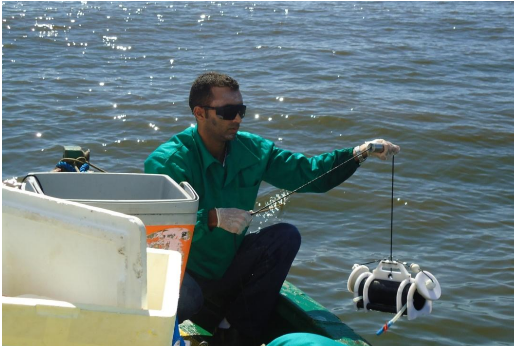
Figura 4.1-73 - Coleta de água para análise laboratorial Ponto Marinho 02 (PM – 02)
