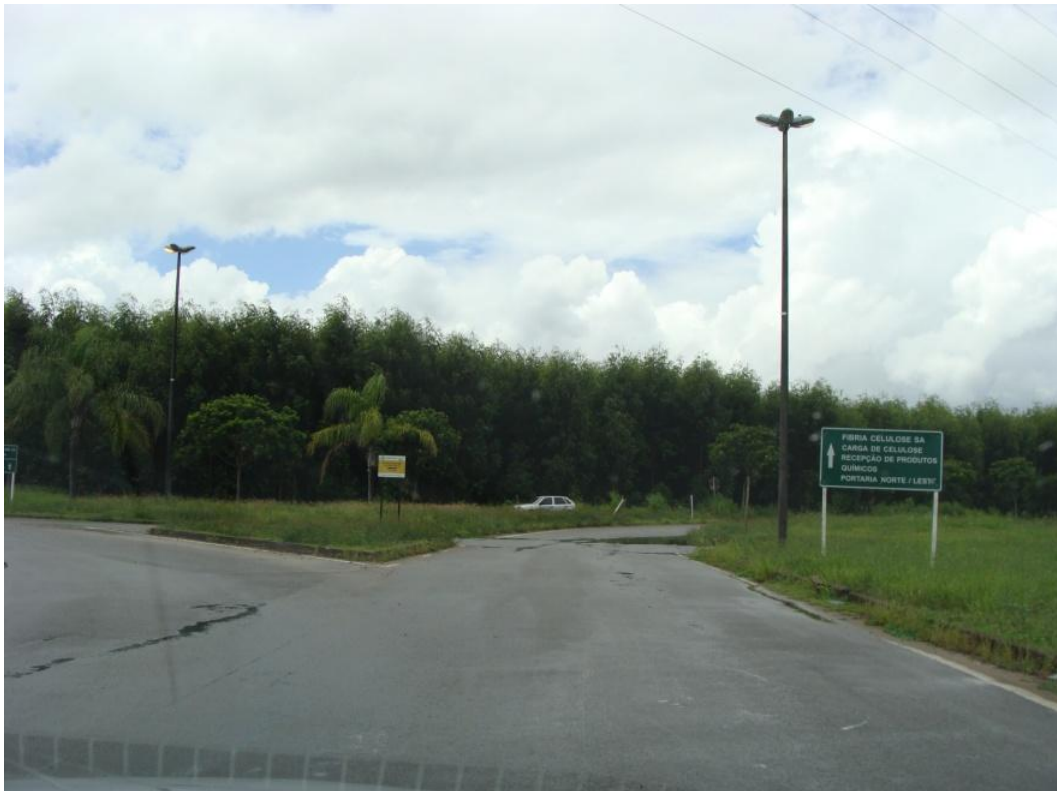
Figura 1.3-29 – Sentido Vitória Aracruz baixo volume, fluxo livre e sem presença de comboios. Característica de nível de serviço A
