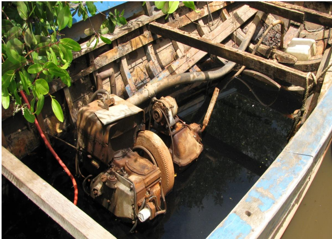
Figura 4.1-61 – Barco em deterioração com uma espessa camada de óleo que vaza gradativamente para o rio
