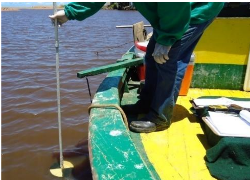
Figura 4.1-71 – Medição de transparência da água com uso do disco de Sacchi
