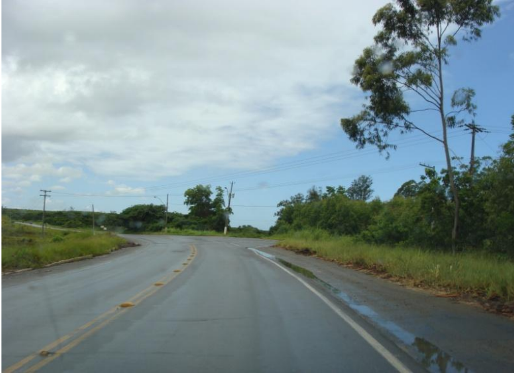
Figura 1.3-31– Sentido Aracruz Linhares - baixo volume, fluxo livre e sem presença de comboios. Característica de nível de serviço A
