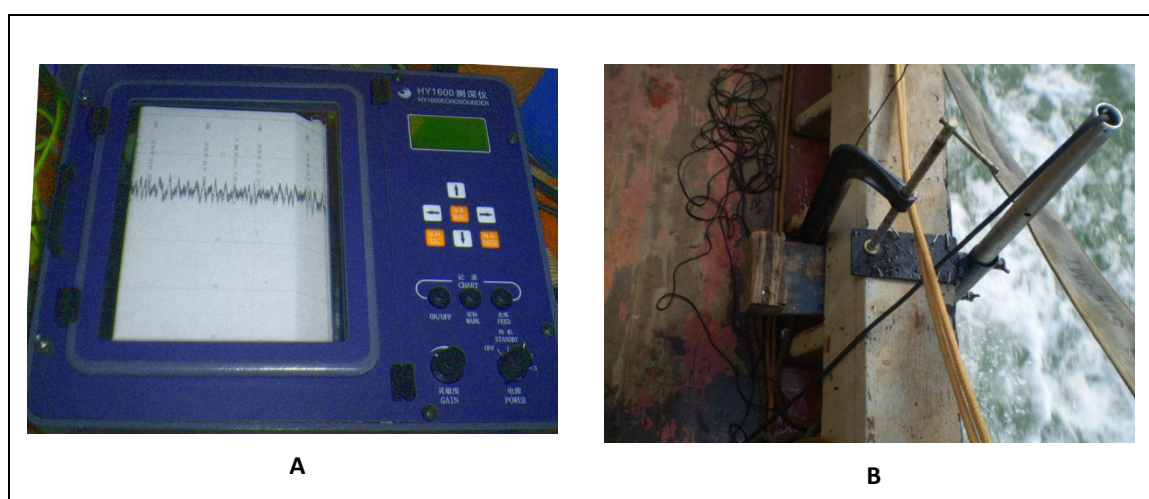
Figura 9 - Ecobatímetro (A) e montagem do transdutor (B).
