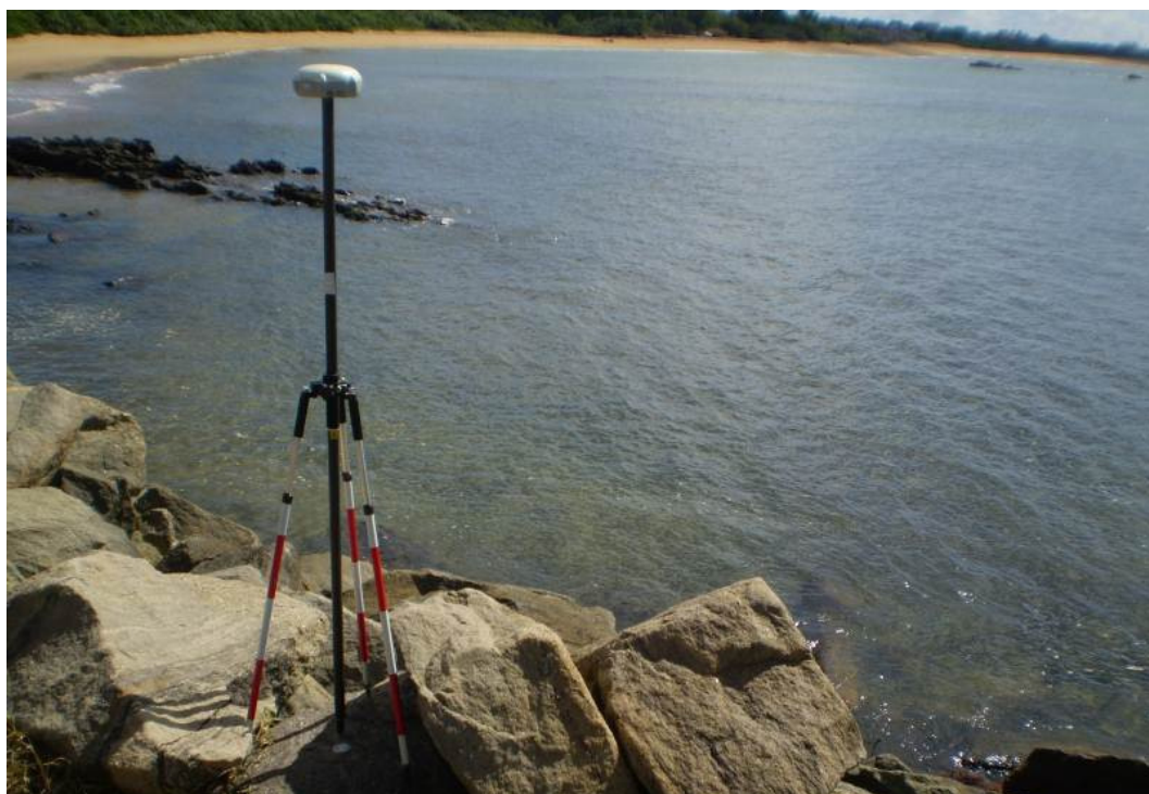
Figura 6 – GPS de precisão L1L2 posicionado na área de estudo (Marco M01)
