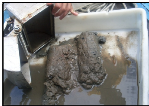
FIGURA 13 – Coleta de sedimento no canal do rio Paraguaçu com draga de Van Veen.
