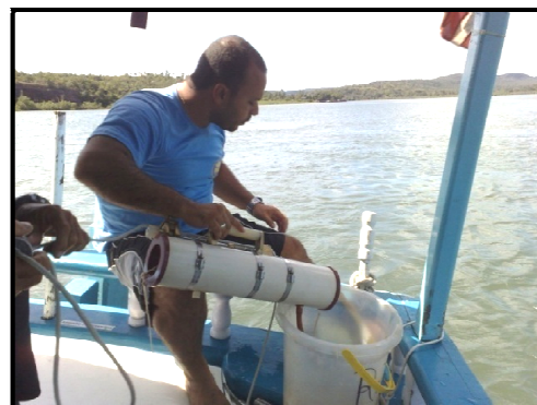
FIGURA 12 – Garrafa amostradora para coleta na coluna d'água.
