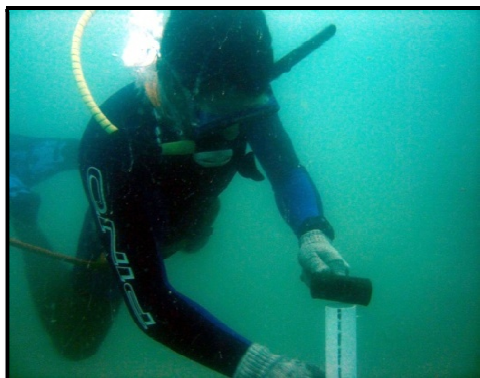
FIGURA 14 - Coleta de testemunho de sedimento com tubo de PVC, na Ponta do Corujão.
