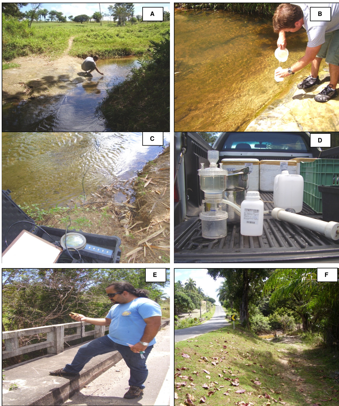
FIGURA 5.1.1.4- 4 – A – Coleta de coliformes termotolerantes; B – Coleta; C – sonda multi-paramétrica; D – filtragem das amostras de metais dissolvidos; E – Registro de localização em GPS das estações de amostragem; F – Via de acesso a uma das estações.
