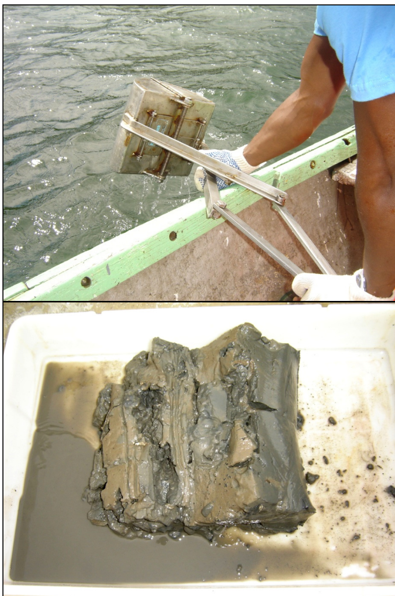
FIGURA 5.1.1.2- 2 – Rotina de coleta das amostras de sedimentos para análises granulométricas.
