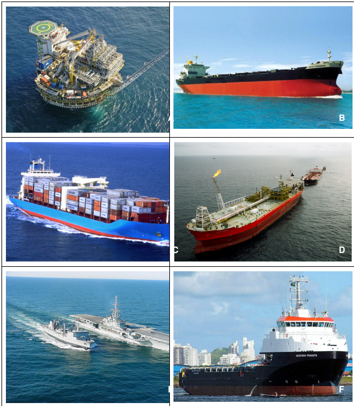
FIGURA 2.2.1-1 – A- Plataforma Semi-submersível, B- Bulk Carrier, C-Full Containers, D- FPSO'S, E - Embarcações Militares, F-Embarcação de Apoio.
